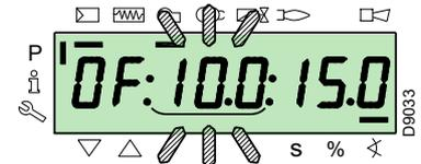
Pour le servomoteur de l'air, continuer à appuyer sur la touche «A» (la position en degrés clignote) et appuyer sur les touches «+» ou «-» pour augmenter ou diminuer la valeur.
