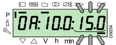
Pour le réglage de la vitesse de l'inverter (exprimée en % à savoir **50 Hz = 100 %**), maintenir la pression sur les touches «F» et «A» simultanément la position en pourcentage clignote et appuyer sur les touches «+» ou «-» pour augmenter ou diminuer la valeur.
