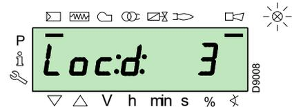
L'afficheur affiche alternativement un code et un diagnostic d'erreur, qui ne met pas le système en sécurité.
