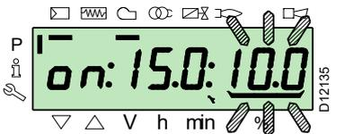
Sélectionner un autre point ou sortir en appuyant simultanément sur les touches «+» et «-» (**ESC**).
