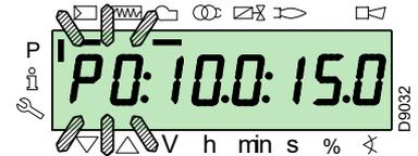
Pour le servomoteur du combustible, continuer à appuyer sur la touche «F» (la position en degrés clignote) et appuyer sur les touches «+» ou «-» pour augmenter ou diminuer la valeur.
