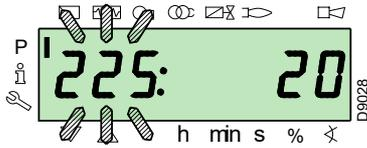
Si la valeur ne s'affiche pas, appuyer sur la touche «i/reset» pendant un temps compris entre 1 et 3 s. Un exemple de modification du paramètre du **temps de pré-ventilation** (n. 225) est reproduit ci-dessous. Appuyer sur la touche «i/reset»: la valeur **20** (secondes) s'affiche.
