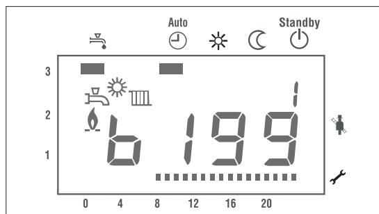
La modifica si rende necessaria per prevenire l'arresto ed il conseguente blocco della caldaia per intervento dell'allarme di per alta temperatura.
