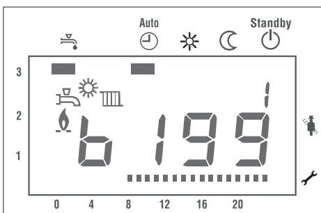
Deze stop wordt aangegeven met een algemene en tijdelijke signalering (\*\* code B199 – Algemene signalering volgens tabel), die automatisch wordt teruggesteld wanneer de toevoertemperatuur afneemt (op het display verschijnt tevens het nummer van de module waarop de signalering betrekking heeft).
