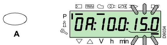
Pour le réglage de la vitesse de l'inverter (exprimée en % à savoir **50 Hz = 100 %**), maintenir la pression sur les touches «F» et «A» simultanément la position en pourcentage clignote et appuyer sur les touches «+» ou «-» pour augmenter ou diminuer la valeur.
