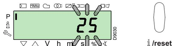
Pour revenir à la liste des paramètres, appuyer simultanément sur les touches «**+**» et «**-**» (**ESC**).
