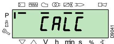
L'équipement calculera automatiquement les points de «P8» à «P2», en les distribuant sur une droite. Ils sont théoriques et doivent être vérifiés.
