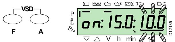
Sélectionner un autre point ou sortir en appuyant simultanément sur les touches «+» et «-» (**ESC**).
