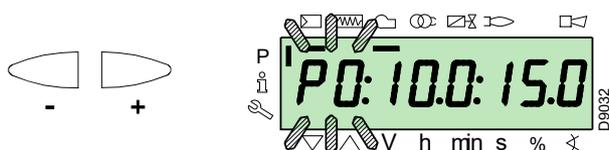
Pour le servomoteur du combustible, continuer à appuyer sur la touche «F» (la position en degrés clignote) et appuyer sur les touches «+» ou «-» pour augmenter ou diminuer la valeur.
