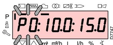
Avec les touches «**+**» et «**-**» entrer/sélectionner le point désiré de la courbe et attendre qu'il clignote: cela veut dire que les servomoteurs se sont positionnés sur les valeurs sélectionnées sur l'afficheur et qu'elles correspondent au point configuré auparavant.
