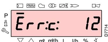
L'afficheur visualise alternativement le code d'erreur (dans l'exemple sur le côté **c**: 12) et le diagnostic correspondant (dans l'exemple **d**: 0).
