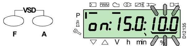
Sélectionner un autre point ou sortir en appuyant simultanément sur les touches «+» et «-» (**ESC**).
