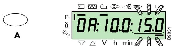
Pour le réglage de la vitesse de l'inverter (exprimée en % à savoir **50 Hz = 100 %**), maintenir la pression sur les touches «F» et «A» simultanément la position en pourcentage clignote et appuyer sur les touches «+» o «-» pour augmenter ou diminuer la valeur.
