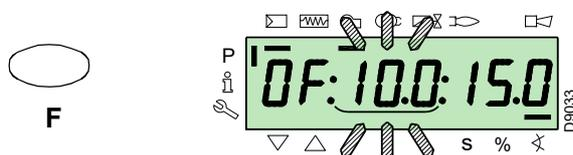
Pour le servomoteur de l'air, continuer à appuyer sur la touche «A» (la position en degrés clignote) et appuyer sur les touches «+» ou «-» pour augmenter ou diminuer la valeur.
