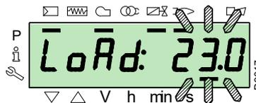
Pour quitter le mode manuel, appuyer simultanément sur les touches «+» et «-» (ESC) pendant 3 secondes: le brûleur fonctionnera en automatique et la puissance dépendra du thermostat/pressostat de réglage (TR).
