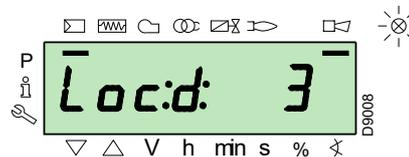
L'afficheur affiche alternativement un code et un diagnostic d'erreur, qui ne met pas le système en sécurité.
