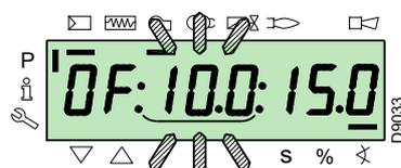
Pour le servomoteur de l'air, continuer à appuyer sur la touche «A» (la position en degrés clignote) et appuyer sur les touches «+» ou «-» pour augmenter ou diminuer la valeur.
