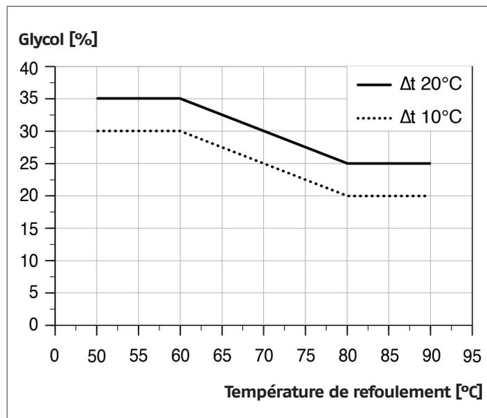
Pour le calcul de la température de congélation associée au mélange utilisé, se référer à la fiche technique du produit utilisé.
