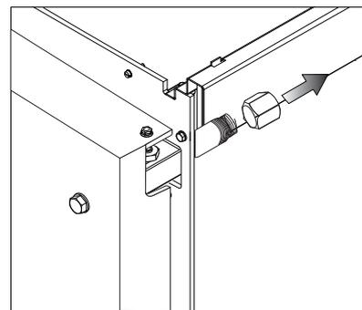
Ouvrir la porte et enlever, à l'aide d'une scie adéquate ou d'une lime, la débouchure sur le côté opposé à celui de la tête de porte (aussi bien dessus que dessous).
