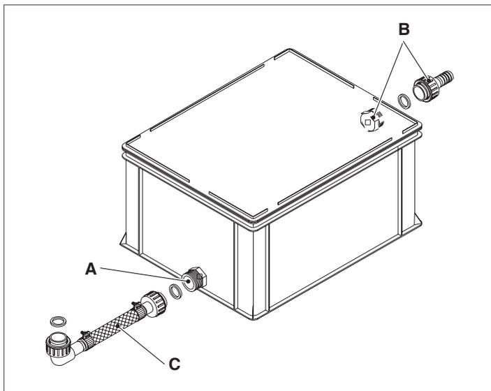
Le d'entrée (A) de l'unité de neutralisation N2 (le plus bas) doit être raccordé à l'évacuation des condensats de la chaudière avec le tuyau flexible (C) fourni avec l'unité. Cela garantit l'absence de fuites de produits de la combustion par la tuyauterie d'évacuation des condensats de la chaudière.
