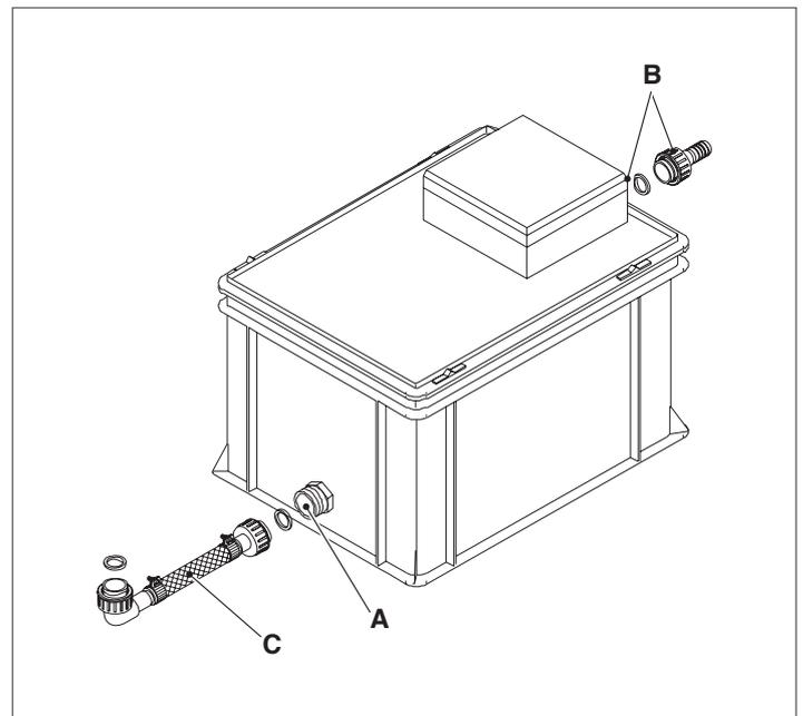
Le d'entrée (A) de l'unité de neutralisation N2 (le plus bas) doit être raccordé à l'évacuation des condensats de la chaudière avec le tuyau flexible (C) fourni avec l'unité. Cela garantit l'absence de fuites de produits de la combustion par la tuyauterie d'évacuation des condensats de la chaudière.
