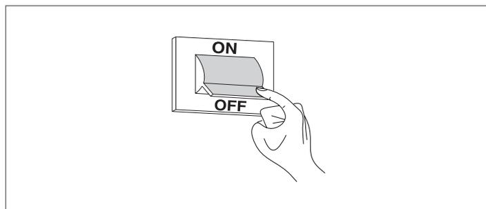
Si toutes les conditions sont satisfaites, redémarrer l'appareil, effectuer un contrôle de la combustion (analyse des fumées), du débit du combustible et de l'étanchéité du joint de la porte.
