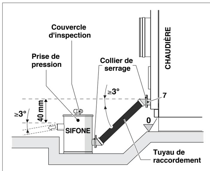
**⚠** Avant d'effectuer la mise en service, remplissez le siphon avec de l'eau jusqu'au niveau « L » au niveau du raccord supérieur.
