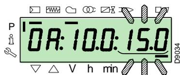
Pour le réglage de la vitesse de l'inverter (exprimée en % à savoir **50 Hz = 100 %**), maintenir la pression sur les touches «F» et «A» simultanément la position en pourcentage clignote et appuyer sur les touches «+» o «-» pour augmenter ou diminuer la valeur.
