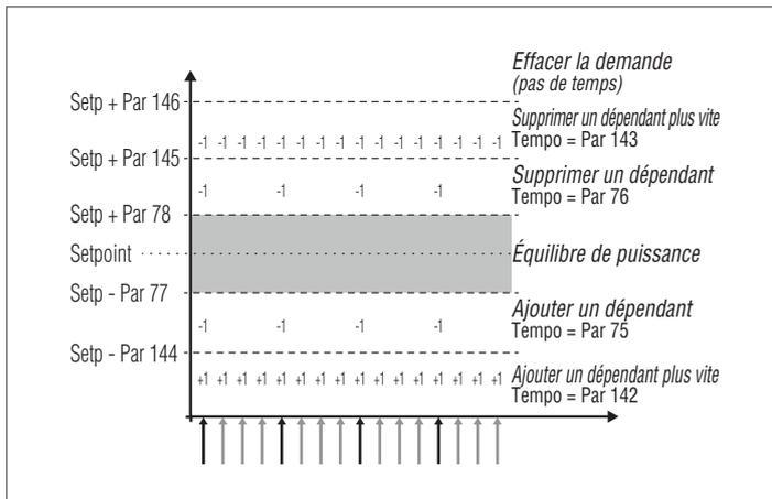
Six bandes sont définies sur la base de la température lue (par le module de gestion) sur le collecteur de refoulement du circuit primaire.
