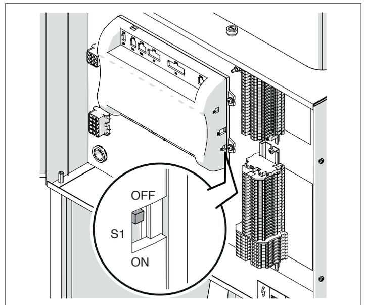
Mettez l'interrupteur principal du système sur ON et UNIQUEMENT l'interrupteur principal du module thermique à configurer sur (I).
