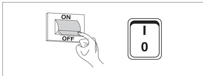
Si toutes les conditions sont remplies, mettre sous tension le module thermique en mettant l'interrupteur général de l'installation et l'interrupteur principal de l'appareil sur « Allumé », puis effectuer l'analyse des produits de combustion (voir paragraphe « Réglages »).
