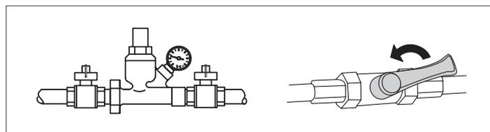
**⚠** En cas de risque de gel, vidanger les installations thermique et sanitaire.
