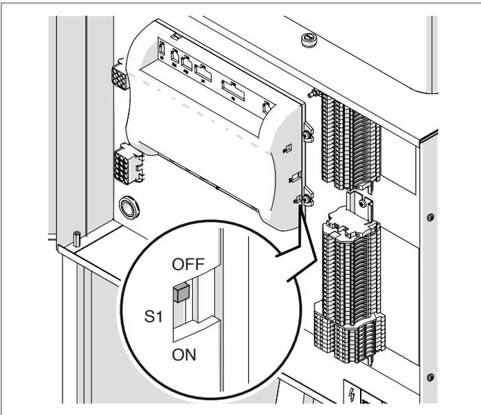
Mettre l'interrupteur principal du système sur ON et UNIQUEMENT l'interrupteur principal du module thermique à configurer sur (I).
