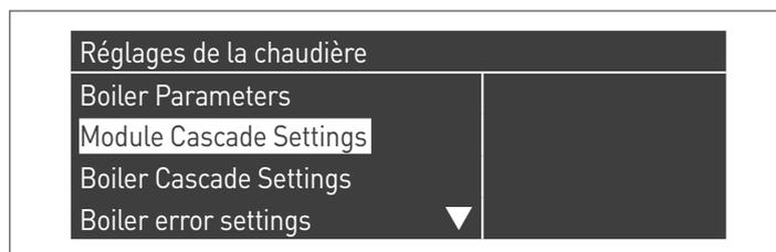
Confirmer avec la touche ● et sélectionner « (189) Burner Address » à l'aide des touches ▲/▼
