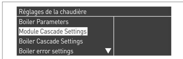
Confirmer avec la touche ● et sélectionner « (189) Burner Address » à l'aide des touches ▲/▼
