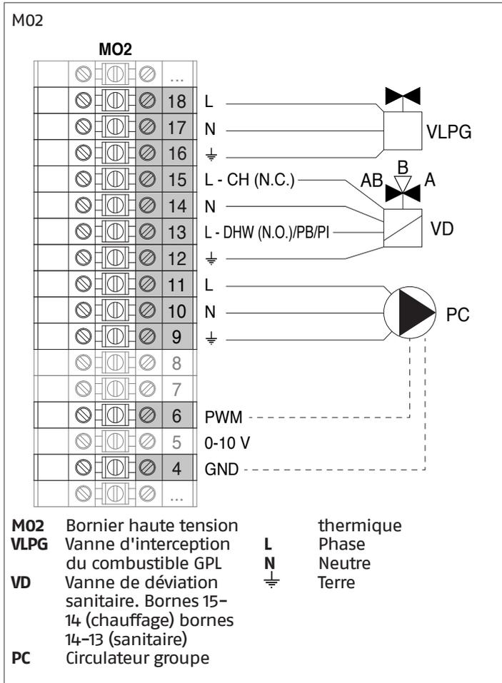
Configuration paramètres de base Schéma 4
