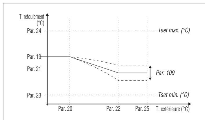
La demande est activée lorsque le contact du thermostat d'ambiance/de la demande de chauffage se ferme, à condition que la température extérieure ne dépasse pas la valeur définie par le paramètre 25.
