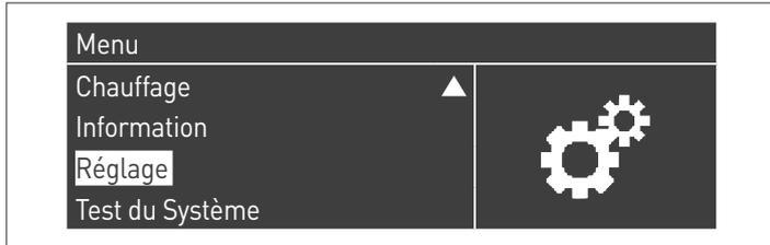
Confirmer avec la touche ● et sélectionner « Réglages de la chaudière » à l'aide des touches ▲/▼
