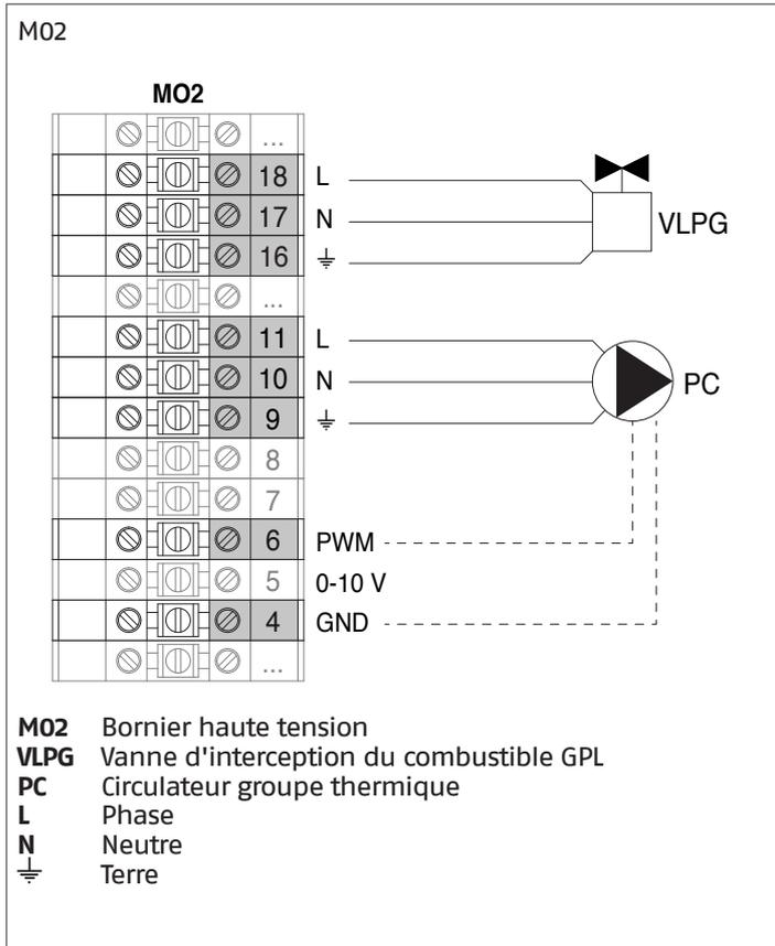
Configuration paramètres de base Schéma 1
