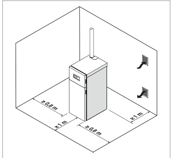
Le module thermique **TAU Unit** peut être installé dans des locaux ventilés en permanence et équipés d'ouvertures de ventilation de taille adéquate, conformément aux règlements techniques et aux réglementations en vigueur sur le site d'installation.
