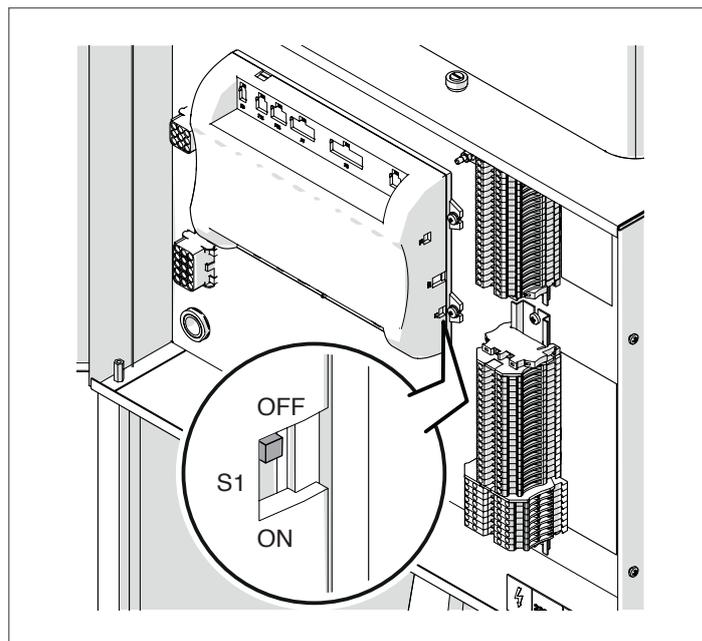
Mettre l'interrupteur principal du système sur ON et **UNIQUEMENT** l'interrupteur principal du module thermique à configurer sur (i).
