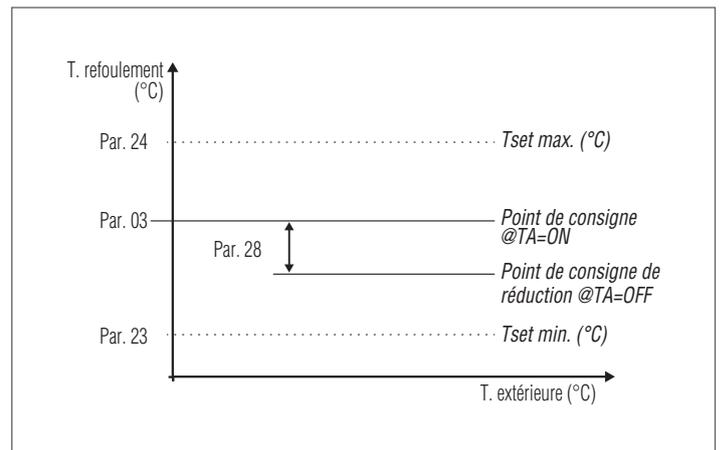
**⚠** La sonde extérieure (accessoire) n'est pas nécessaire et si elle est connectée, la valeur de température extérieure mesurée n'a pas d'influence sur le point de consigne réglé.
