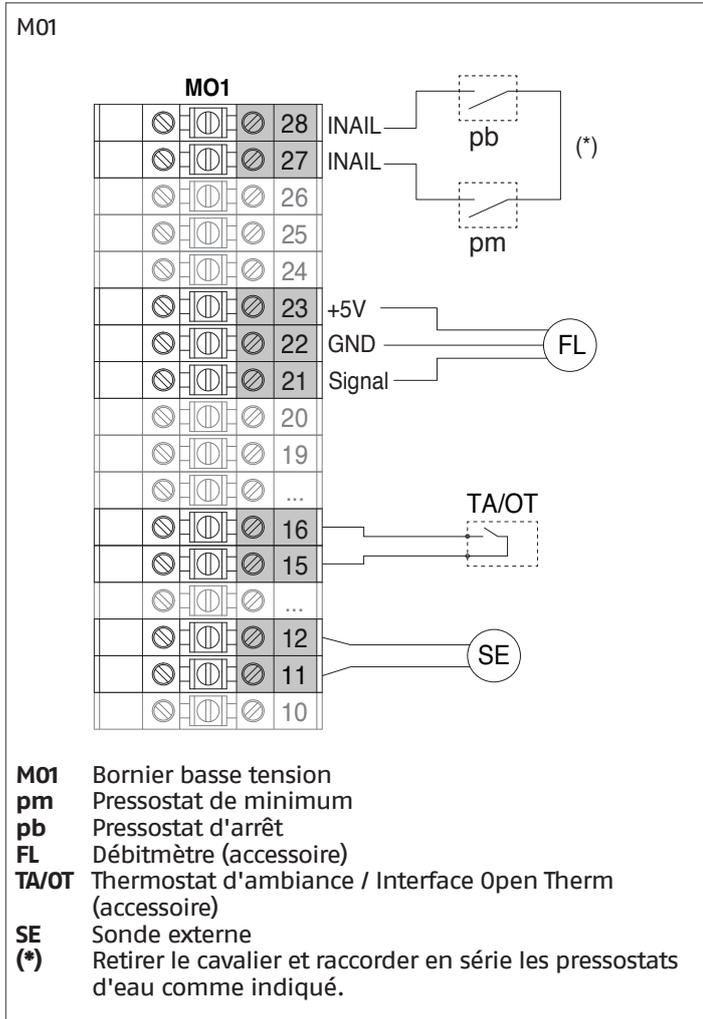
Schéma 1.1 : circuit avec module thermique connecté directement à l'installation avec deux zones de chauffage directes
