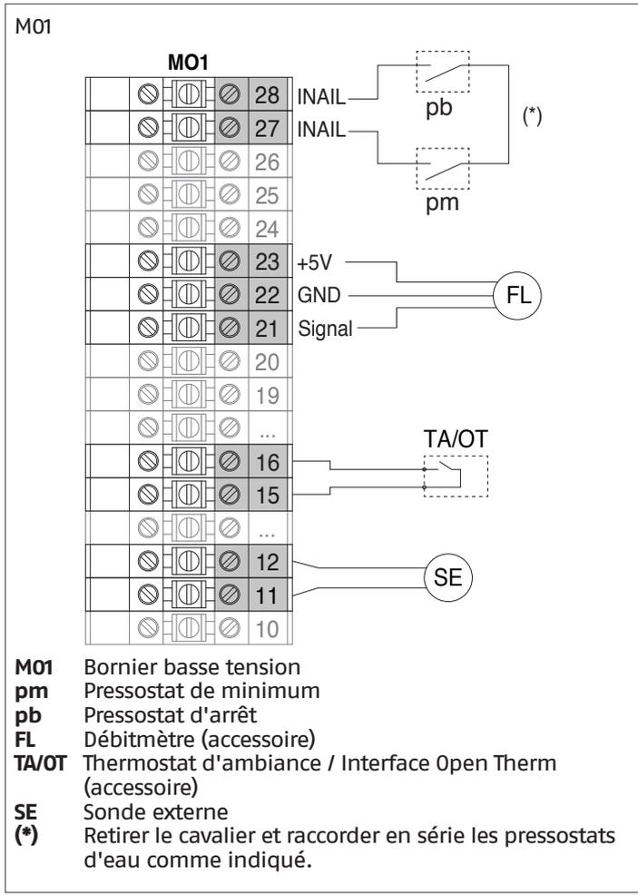
Configuration paramètres de base Schéma 1.1
