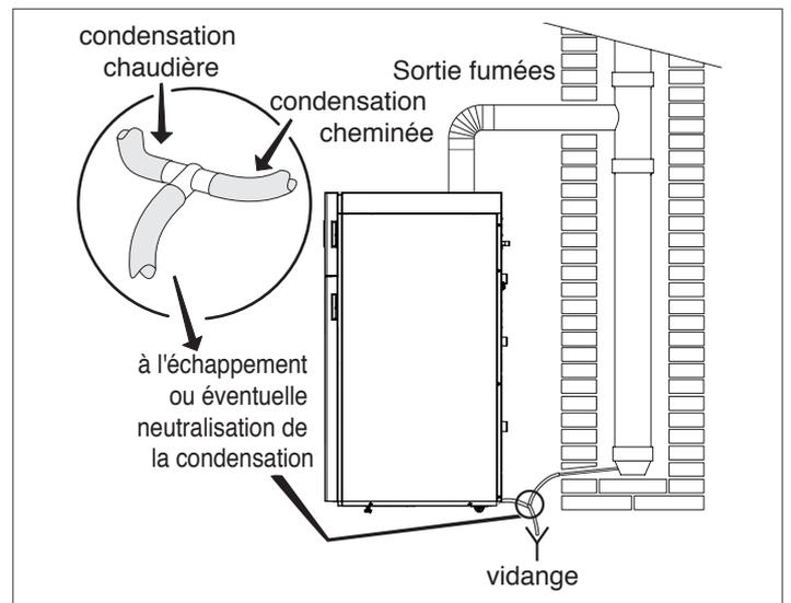
⚠ Tout dispositif éventuel destiné à la neutralisation du condensat pourra être relié après le siphon. Pour le calcul de la durée de la charge de neutralisation, il faut que soit évalué l'état de consommation du dispositif de neutralisation après une année de fonctionnement. Sur la base de cette information, il sera possible d'extrapoler la durée totale de la charge.
