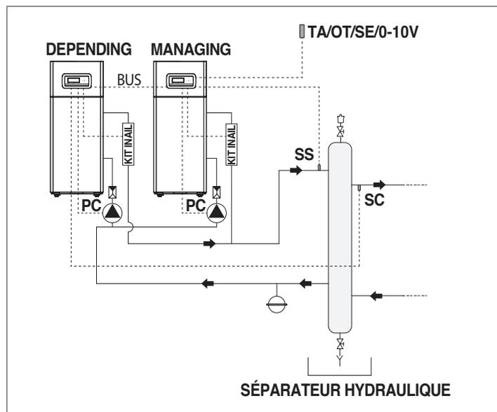
Par souci de simplicité, nous identifions les circuits hydrauliques en aval du séparateur comme secondaires. La configuration de base du circuit secondaire comporte l'utilisation d'un circulateur d'installation (PI). Ce circulateur, raccordé aux modules en cascade, permet de gérer le transfert d'énergie thermique vers un circuit utilisateur, par exemple une zone directe pour le chauffage d'ambiance à haute température.
