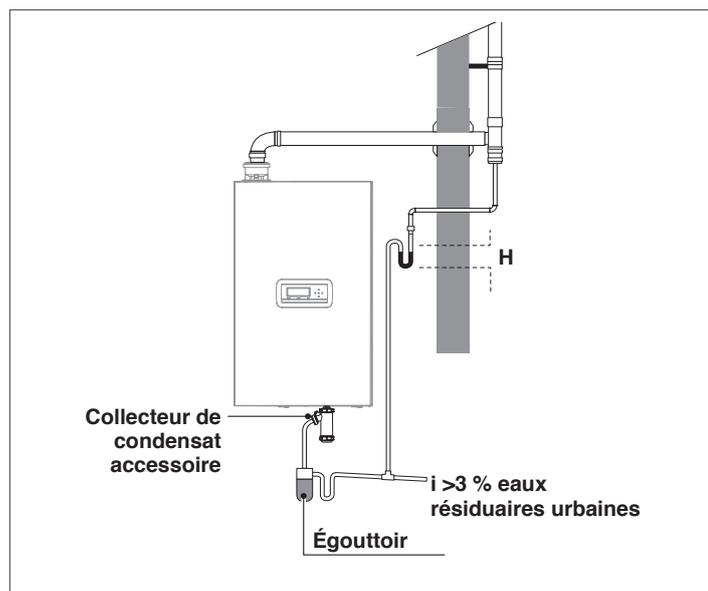
**⚠** Réaliser l'évacuation des condensats de manière à éviter toute fuite des produits de combustion gazeux dans l'environnement ou dans les égouts, en dimensionnant le siphon (hauteur H) comme décrit au paragraphe « Évacuation des produits de la combustion ».
