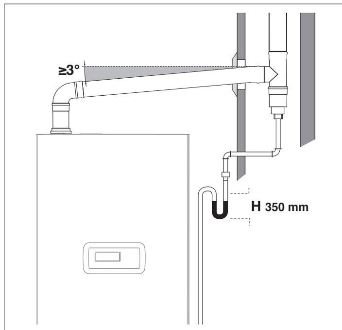
Pour les changements de direction, utiliser un raccord en T avec un bouchon d'inspection qui facilite le nettoyage périodique des conduites. Toujours s'assurer, après le nettoyage, que les bouchons d'inspection sont hermétiquement refermés et que leur joint est intact.
