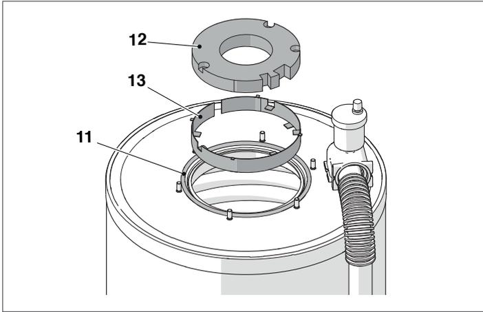
Une fois les opérations d'entretien effectuées, remonter les composants en opérant dans le sens inverse des indications, et en serrant les vis avec un couple 5Nm.
