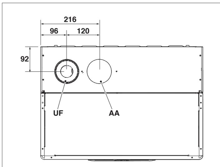
La sortie AA sort d'usine bouchée en configuration B23.
