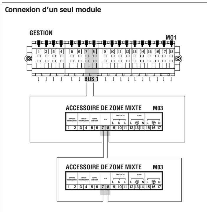
La commande électronique du module thermique vérifie automatiquement quelles zones sont connectées sur le bus.
