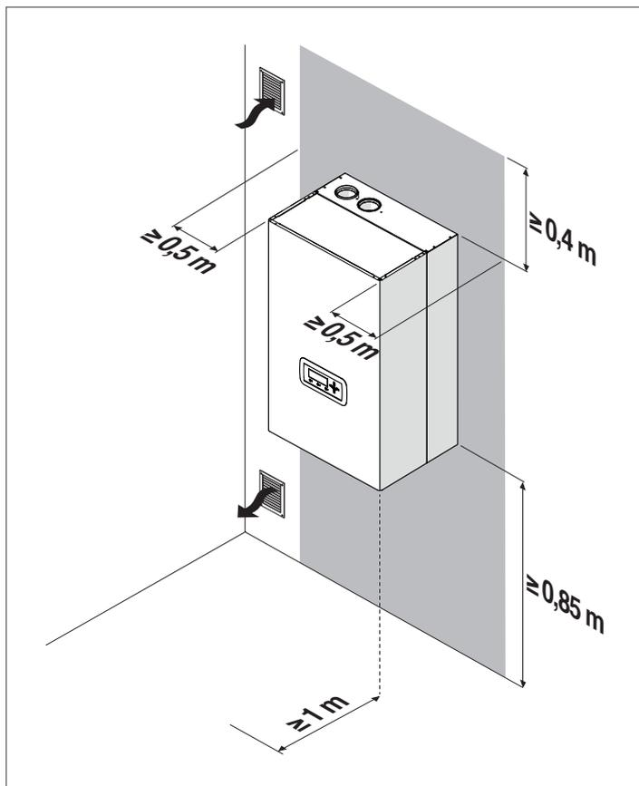
La surface minimale des ouvertures de ventilation est de 3000 cm<sup>2</sup> pour les systèmes de chauffage à combustibles gazeux.
