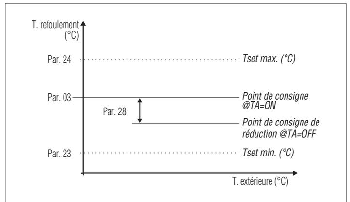
**!** La sonde extérieure (accessoire) n'est pas nécessaire et si elle est connectée, la valeur de température extérieure mesurée n'a pas d'influence sur le point de consigne réglé.
