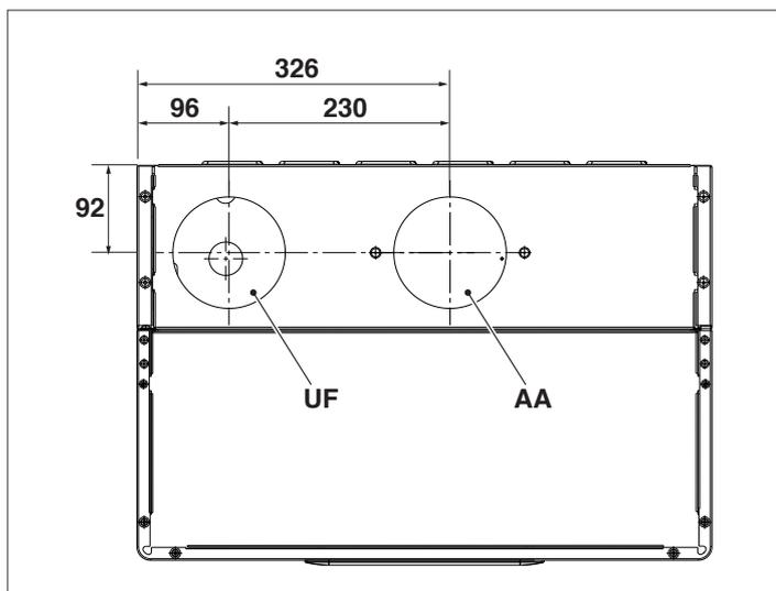
La sortie AA sort d'usine bouchée en configuration B23.
