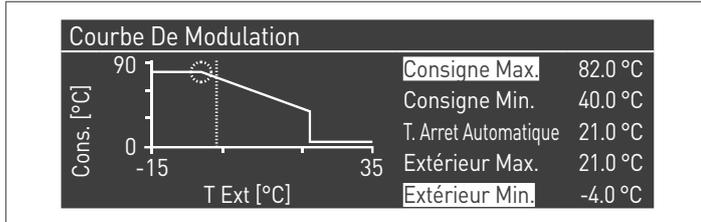
Le paramètre « Comp. T. @ T. ext. max. », s'il est différent de 0, transforme la courbe climatique de linéaire en quadratique, permettant de mieux adapter la variation du point de consigne à la variation de la température extérieure.
