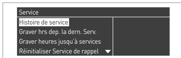
Le menu « Réglages » → « Régl. chaudière » → « Entretien » affiche les commandes avancées de cette fonction, mais celles-ci ne sont accessibles qu'avec le mot de passe du fabricant. S'il est nécessaire d'agir à ce niveau d'accès, contacter le Service d'Assistance Technique.
