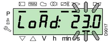
Pour quitter le mode manuel, appuyer simultanément sur les touches «+» et «-» (ESC) pendant 3 secondes: le brûleur fonctionnera en automatique et la puissance dépendra du thermostat/pressostat de réglage (TR).
