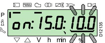
Sélectionner un autre point ou sortir en appuyant simultanément sur les touches «+» et «-» (**ESC**).
