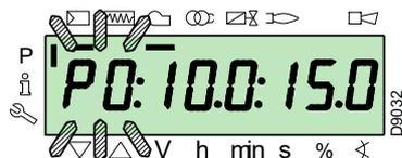
Pour le servomoteur du combustible, continuer à appuyer sur la touche «F» (la position en degrés clignote) et appuyer sur les touches «+» ou «-» pour augmenter ou diminuer la valeur.
