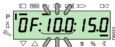
Pour le servomoteur de l'air, continuer à appuyer sur la touche «A» (la position en degrés clignote) et appuyer sur les touches «+» ou «-» pour augmenter ou diminuer la valeur.
