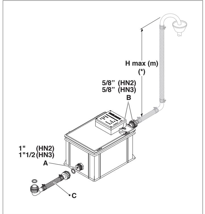
(\*) La charge maximum que la pompe peut supporter est donnée par sa hauteur d'élévation maximum réduite de la résistance offerte par le tuyau d'évacuation.
