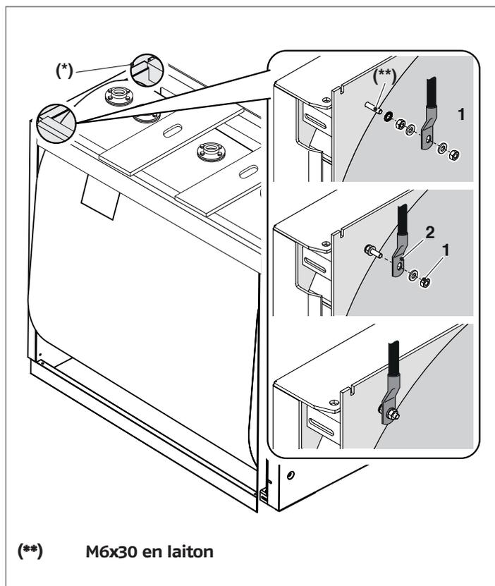
**!** Sur le côté gauche de la face avant se trouve un autre trou (\*) permettant d'effectuer le raccordement de mise à la terre. Si l'on décide d'utiliser cet autre trou pour la mise à la terre, il faut retirer les pièces présentes sur le trou du côté droit et les appliquer du côté gauche.
