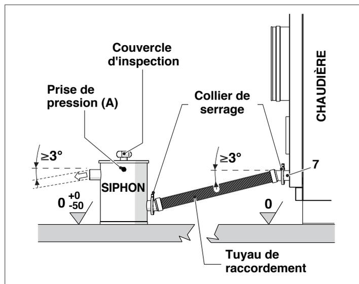
**⚠** Avant d'effectuer la mise en service, remplissez le siphon avec de l'eau jusqu'au niveau « L » au niveau du raccord supérieur.
