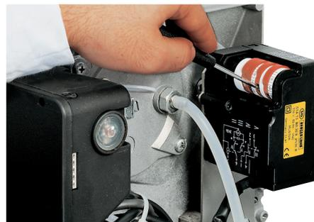
La regolazione della testa è semplice e facilitata da una scala graduata, una presa consente la lettura della pressione aria nella testa di combustione.
