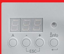
LME71 燃烧安全控制装置可以管理燃烧器运行的各个方面。该控制单元采用简单的三点程序建立燃烧器运行曲线。设备界面具有三位数显和四个按键，为用户提供详细的故障代码信息、火焰信号强度、操作点和设备单元手动控制功能。
