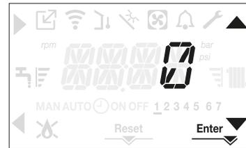
Tutte le volte che la caldaia è alimentata viene eseguito un ciclo di sfiato della durata di 4 min.
