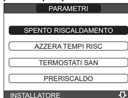
**SPENTO RISCALDAMENTO:** questo parametro consente di modificare la TEMPORIZZAZIONE SPENTO FORZATO RISCALDAMENTO, relativa al tempo di ritardo introdotto per la riaccensione del bruciatore a fronte di uno spento per raggiunta temperatura in riscaldamento. Il valore di fabbrica è di 3 minuti e può essere impostato e confermato ad un valore compreso fra 0 min e 20 min.
