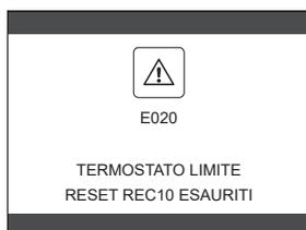
Se i tentativi di ripristino non attiveranno il funzionamento della caldaia, interpellare il Servizio Tecnico di Assistenza.
