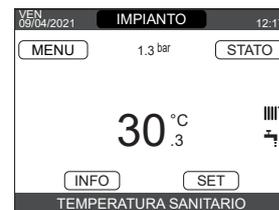
**ESTATE** : selezionando nel menù STATO → CALDAIA → ESTATE si attivano la funzione tradizionale di sola acqua calda sanitaria. Sul REC10REXPH-N viene normalmente visualizzata la temperatura dell'acqua sanitaria erogata dalla caldaia.
