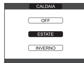
**INVERNO** / : selezionando nel menù STATO → CALDAIA → INVERNO si attivano le funzioni di riscaldamento e acqua calda sanitaria. Sul REC10REXPH-N viene normalmente visualizzata la temperatura dell'acqua sanitaria a meno che non sia in corso una richiesta di riscaldamento, nel qual caso viene visualizzata la temperatura di mandata della caldaia.
