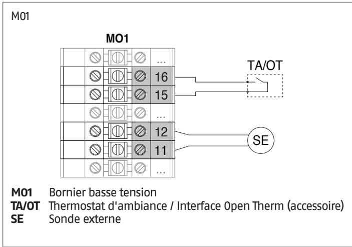
Configuration paramètres de base Schéma 1.1
