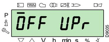
Greifen Sie auf die Passwordebene Parameter zu, siehe dazu "Vorgehensweise zum Zugang mittels Kennwort" auf S. 31. Das Display zeigt die Parametergruppe 400.
