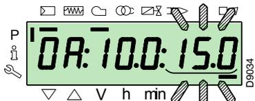
Für die Einstellung der Invertergeschwindigkeit (ausgedrückt in % d. h. **50 Hz = 100 %**), halten Sie die Tasten **“F”** und **“A”** gleichzeitig gedrückt, die Position in Prozenten ausgedrückt blinkt, drücken Sie die Tasten **“+”** oder **“-”**, um den Wert zu erhöhen oder zu verringern.
