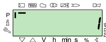
Nach ca. 5 Sekunden (hängt von der Dauer des Programms ab), erscheint der Wert **0** am Display, dies weist darauf hin, dass der Backup-Vorgang korrekt abgeschlossen wurde.
