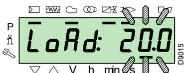
Beim Loslassen der Taste "F" erscheint die Standard-Anzeige mit blinkender Angabe des aktuellen Lastanteils: dies bedeutet, dass der Brenner manuell arbeitet (jegliche externe Regelung wird ausgeschlossen und es sind nur die Sicherheitsvorrichtungen aktiv).
