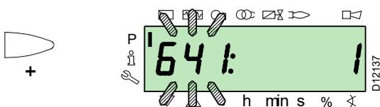
Stellen Sie den Parameter **641 = 1** ein. Drücken Sie die Taste **"i/reset"**, die Phase "Standardisierung der VSD-Geschwindigkeit" beginnt.
