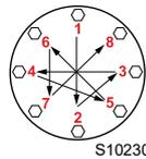
Die Muttern schrittweise (erst auf 30 %, dann auf 60 % bis schließlich auf 100 %) entsprechend dem abgebildeten Überkreuzschema anziehen.
