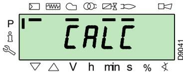
Das Steuergerät wird automatisch die Punkte von “P8” bis “P2” berechnen, und sie auf einer Geraden verteilen. Diese Daten sind theoretisch und müssen geprüft werden.
