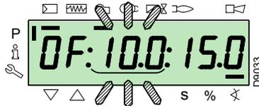
Halten Sie für den Stellantrieb der Luft die Taste "A" gedrückt (die Position in Grad blinkt) und drücken Sie die Tasten "+" oder "-", um den Wert zu erhöhen oder zu verringern.
