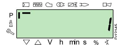
Nach ca. 5 Sekunden (hängt von der Dauer des Programms ab), erscheint der Wert 0 am Display, dies weist darauf hin, dass der Backup-Vorgang korrekt abgeschlossen wurde.
