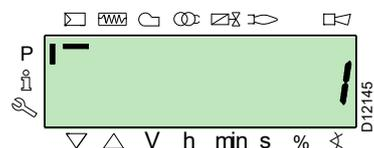
Nach etwa 8 Sekunden (je nach Dauer des Programms) erscheint auf der Anzeige der Wert **0**, was anzeigt, dass der Wiederherstellungsvorgang korrekt abgeschlossen wurde.
