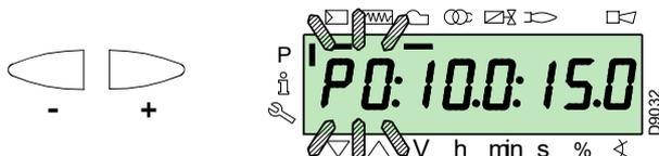
Beim Stellantrieb des Brennstoffs die Taste „F“ gedrückt halten (die Position in Grad blinkt), dann die Taste „+“ oder „-“-Taste drücken, um den Wert zu erhöhen oder zu verringern.
