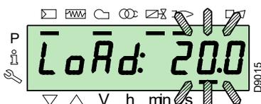
Wenn die Taste „F“ losgelassen wird, erscheint die Standardanzeige mit blinkendem Prozentsatz der aktuellen Last: dies bedeutet, dass der Brenner im manuelle Betrieb läuft (eine externe Regelung ist ausgeschlossen, nur die Sicherheitsvorrichtungen sind aktiv).
