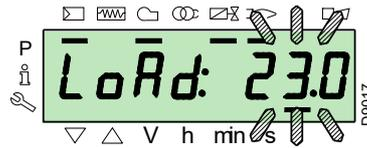
Um den manuellen Modus zu beenden, die Tasten „+“ und „-“ (ESC) gleichzeitig 3 Sekunden lang drücken: der Brenner wird automatisch funktionieren und die Leistung wird vom Thermostat/Druckregler (TR) abhängen.
