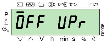
Wie unter „Zugangsvorgang mit Passwort“ auf Seite 37 beschrieben, auf die Parameterebene zugreifen. Das Display zeigt die Parametergruppe 400 an.
