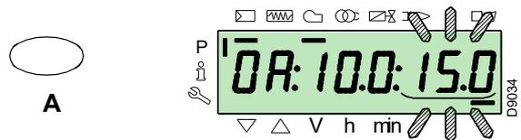
Um die Geschwindigkeit des Umrichters (ausgedrückt in %, d. h. 50 Hz = 100 %) einzustellen, die Tasten „F“ und „A“ gleichzeitig gedrückt halten, die Position in Prozent blinkt, dann die Taste „+“ oder „-“ drücken, um den Wert zu erhöhen oder zu verringern.
