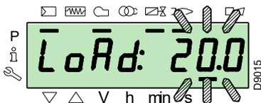
Wenn die Taste „F“ losgelassen wird, erscheint die Standardanzeige mit blinkendem Prozentsatz der aktuellen Last: dies bedeutet, dass der Brenner im manuellen Betrieb läuft (eine externe Regelung ist ausgeschlossen, nur die Sicherheitsvorrichtungen sind aktiv).
