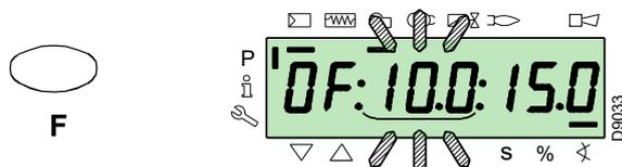
Beim Stellantrieb der Luft die Taste „A“ gedrückt halten (die Position in Grad blinkt), dann die Taste „+“ oder „-“-Taste drücken, um den Wert zu erhöhen oder zu verringern.
