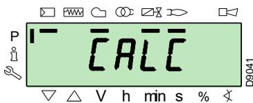
Die Flammensteuerung wird automatisch die gleichen Werte, die unter den Punkten „P0“ und „P1“ eingestellt wurden, an den Punkten „P2“ bis „P8“ ansetzen.
