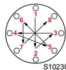
Die Muttern schrittweise (erst auf 30 %, dann auf 60 % bis schließlich auf 100 %) entsprechend dem abgebildeten Überkreuzschema anziehen.
