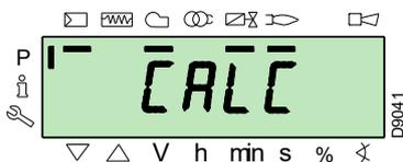
Die Flammensteuerung berechnet automatisch die Punkte von „P8“ bis „P2“ und verteilt sie auf einer geraden Linie. Sie sind theoretisch und müssen überprüft werden.
