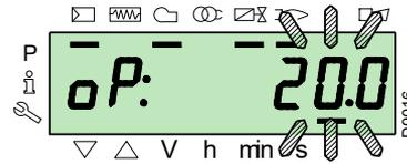
Halten Sie die Taste "F" gedrückt und erhöhen bzw. verringern Sie mit den Tasten "+" oder "-" den Lastanteil.
