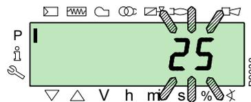
Betätigen Sie, um zur Parameterliste zurückzuschalten, gleichzeitig die Tasten "+" und "-" (ESC).
