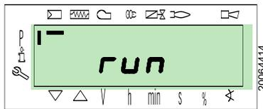
Mit der Taste "i/reset" bestätigen. Der Brenner startet.
