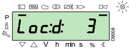
Betätigen Sie zum Entstören die Taste "i/reset" für 1s: auf dem Display erscheint "rESEt". Beim Loslassen der Taste verlöschen die Störungsmeldung und die rote Kontrollleuchte. Das Steuergerät ist entstört.
