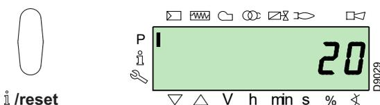
Betätigen Sie die Taste "+" und erhöhen Sie den Wert auf 25 s (blinkend). Betätigen Sie zum Bestätigen und Speichern die Taste "i/reset".
