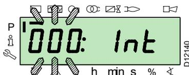
Der Parameter **000** blinkt, mit der Taste "i/reset" bestätigen:
