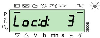
Betätigen Sie zum Entstören die Taste "i/reset" für 1s: auf dem Display erscheint "rESEt". Beim Loslassen der Taste verlöschen die Störungsmeldung und die rote Kontrollleuchte. Das Steuergerät ist entstört.
