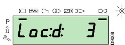
Das Display zeigt abwechselnd einen Code und eine Diagnose des Fehlers an, wobei das System nicht in einen sicheren Zustand versetzt wird.
