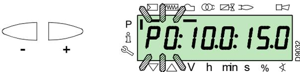
Halten Sie für den Stellmotor des Brennstoffs die Taste "F" gedrückt (die Position in Grad blinkt) und drücken Sie die Tasten "+" oder "-", um den Wert zu erhöhen oder zu verringern.
