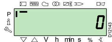
Nach ca. 8 Sekunden (hängt von der Dauer des Programms ab), erscheint der Wert 0 am Display, dies weist darauf hin, dass der Restore-Vorgang korrekt abgeschlossen wurde.
