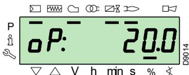
Betätigen Sie die Taste "F" für 1 s: es erscheint "LoAd" und der Prozentwert der Belastung blinkt.
