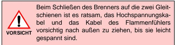
Beim Schließen des Brenners auf die zwei Gleitschienen ist es ratsam, das Hochspannungskabel und das Kabel des Flammenfühlers vorsichtig nach außen zu ziehen, bis sie leicht gespannt sind.
