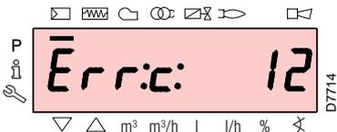
Das Display zeigt abwechselnd den Fehlercode (im nebenstehenden Beispiel **c: 12**) und die entsprechende Diagnose (im Beispiel **d: 0**) an.
