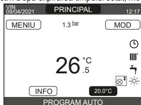
Pentru a activa modul CONFORT, evidențiați temperatura utilizând tastele „+” și „-“. După confirmarea selecției prin apăsarea butonului **ENTER**, valoarea temperaturii va începe să fie afișată intermitent. Apăsați tastele „+” și „-“ pentru a modifica temperatură în trepte de 0,5°C.
