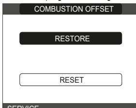
**RESTORE (Wiederherstellen):** Wählen Sie diese Option, wenn die MAIN PCB Platine ausgetauscht wird.
