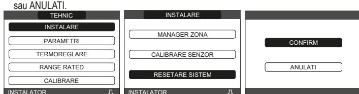
**Observație:** După o resetare, este necesară efectuarea unei noi configurații a sistemului; pentru detalii despre această procedură, consultați secțiunea următoare.
