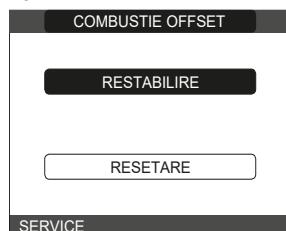
**RESTABILIRE:** selectați această opțiune când înlocuiești placă electronică DE LA AKM
