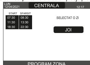
Odată ce selecția a fost efectuată, utilizatorul poate alege dintre următoarele opțiuni: ADAUGA - MODIFICA - STERGE - COPIAZA.
