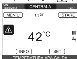
Deplasați-vă pe ecran până când **⚠️** evidențiază pictograma. Se va afișa mesajul de eroare. Ecranul de descriere a defecțiunilor este afișat automat după ce timpul de iluminare a afișajului a trecut, fără apăsarea niciunui buton.
