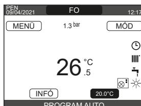
A KOMFORT üzemmód aktiválásához jelölje ki a hőmérsékletet a „+” és „-“ gombokkal. Miután a kiválasztást az ENTER gomb megnyomásával megerősítette, a hőmérséklet értéke villogni kezd. Nyomja meg a „+” és „-“ gombokat a hőmérséklet 0,5 °C-os lépésekben történő módosításához. A kiválasztás megerősítése után egy új képernyő jelenik meg, amely a KOMFORT üzemmód időtartamának beállítására szólítja fel a felhasználót.
