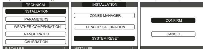
**Anmerkung:** Nach einer Rückstellung muss eine neue Konfiguration der Anlage vorgenommen werden; für Einzelheiten zu diesem Verfahren siehe folgender Abschnitt.
