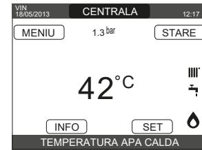
Centrala termică va fi în funcție până la atingerea temperaturii selectate, după care va fi din nou în „așteptare” meninând temperatura pe tur afișată. În cazul apariției defecțiunilor la apărindere sau la funcționare, centrala termică execută o „OPRIRE DE SIGURANȚĂ”, pe REC10CH se va afișa triunghiul care indică defecțiuni. Pentru a identifica codurile de defecțiune și pentru a reseta centrala termică, consultați secțiunea „4.14 Lumini și defecțiuni”.
