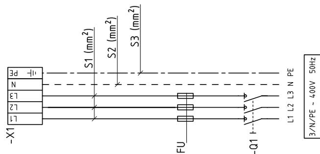
NEL CASO DI INTERRUOTTORE MAGNETOTERMICO
