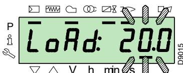
松开“F”键，面板恢复到正常视图，此时负荷比例不断闪烁：此时燃烧器正以“手动”模式运行（不可进行任何外部调节，仅安全设备激活）。
