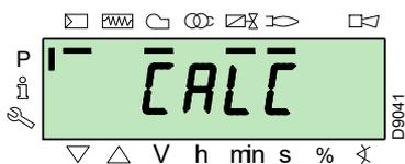
控制器自动计算从点“P8”至点“P2”的值，并分布于曲线上。图中所示为理论数值，实际操作需进行检验。
