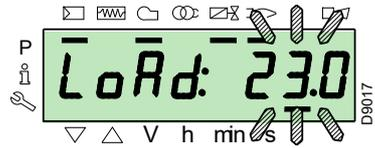
要退出手动模式，需按同时“+”和“-”（ESC）键 3 秒：燃烧器将转换为自动运行模式并根据温控器 / 压力调节开关（TR）调节出力。
