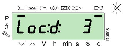
复位时，按下“i/reset”键 1 秒：显示器将出现“rESEt”。松开该键，会锁定信号消失，红色指示灯会熄灭。控制器已复位。
