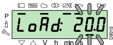
松开“F”键，面板恢复标准视图，当前负荷比例不断闪烁：此时燃烧器正以“手动”模式运行（不可进行任何外部调节，仅激活安全设备）。
