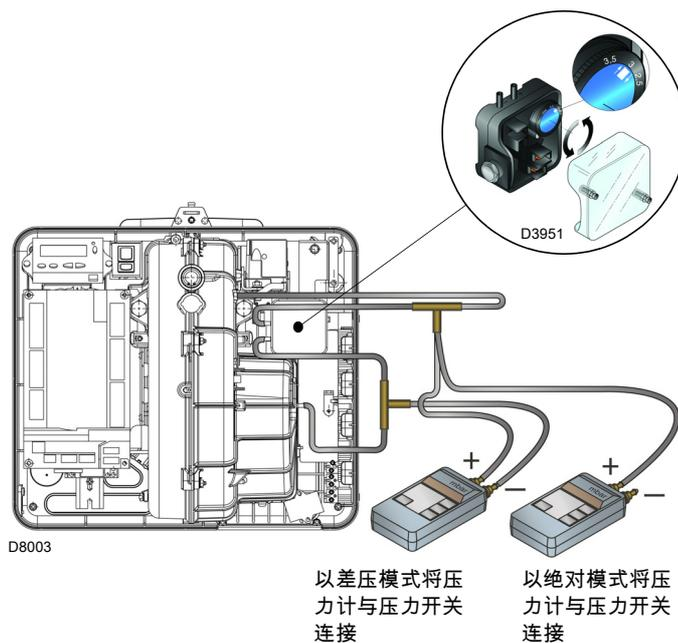
以差压模式将压力计与压力开关连接
