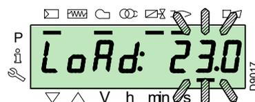
要退出手动模式，需按同时“+”和“-”(ESC)键 3 秒：燃烧器将转换为自动运行模式并根据温控器/压力调节开关 (TR) 调节出力。
