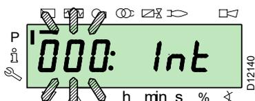
The 000 parameter blinks, confirm using the "i/reset" key:
