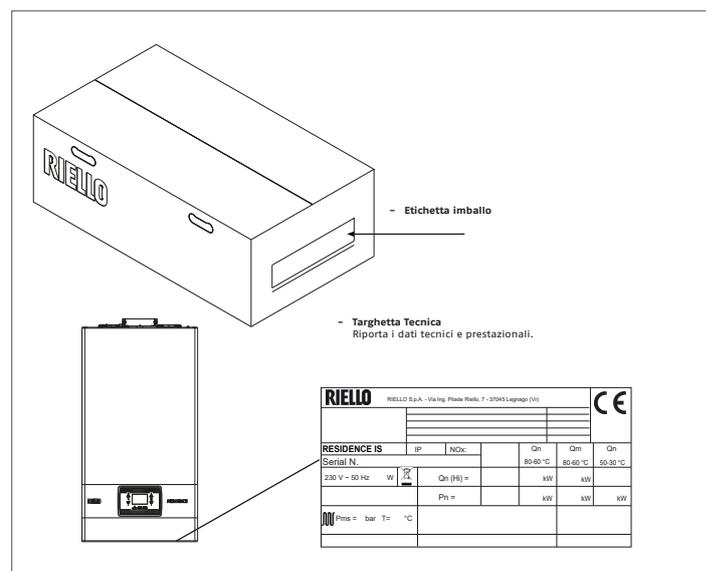
**!** La manomissione, l'asportazione, la mancanza della Targhetta Tecnica o quant'altro non permetta la sicura identificazione del prodotto, rende difficoltosa qualsiasi operazione di installazione e manutenzione.
