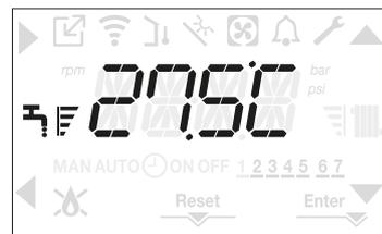
In questo stato la caldaia attiva la funzione tradizionale di sola acqua calda sanitaria, sull'interfaccia viene normalmente visualizzata la temperatura di mandata. In caso di prelievo sanitario il display visualizzerà la temperatura dell'acqua sanitaria.
