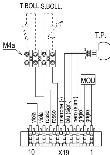
**⚠** Nella configurazione caldaia+bollitore esterno con sonda - CASO C - aggiungere un cavallotto sull'ingresso T. BOLL della morsettiera M4.
