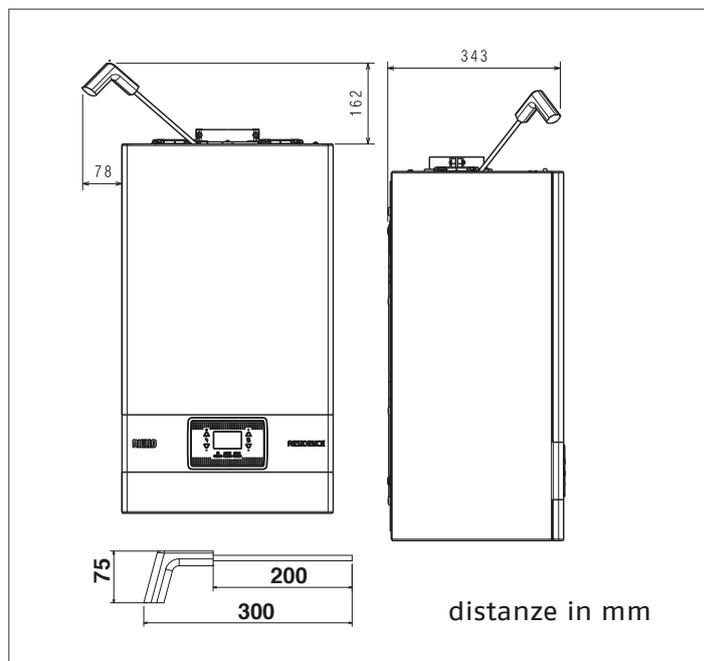
**⚠** In caso di installazione è **INDISPENSABILE** prevedere gli spazi necessari per l'introduzione dello strumento per l'analisi combustione. Riportiamo un disegno campione dove le distanze tra caldaia e pensile/nicchia sono state ottenute utilizzando uno strumento di lunghezza 300 mm. Strumenti di lunghezze superiori necessitano di spazi maggiori.
