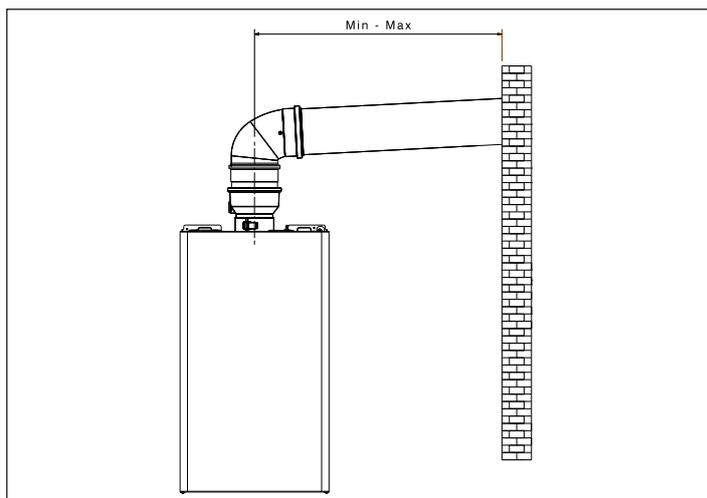
È possibile installare le curve e le prolunghe, disponibili come accessori, in base al tipo di installazione desiderato. Le lunghezze massime consentite del condotto fumi e del condotto aspirazione aria sono riportate nel capitolo "2.12 Scarico fumi ed aspirazione aria comburente".
