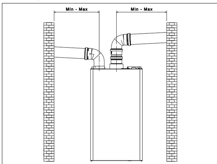
È possibile installare le curve e le prolunghe, disponibili come accessori, in base al tipo di installazione desiderato. Le lunghezze massime consentite del condotto fumi e del condotto aspirazione aria sono riportate nel capitolo "2.12 Scarico fumi ed aspirazione aria comburente".
