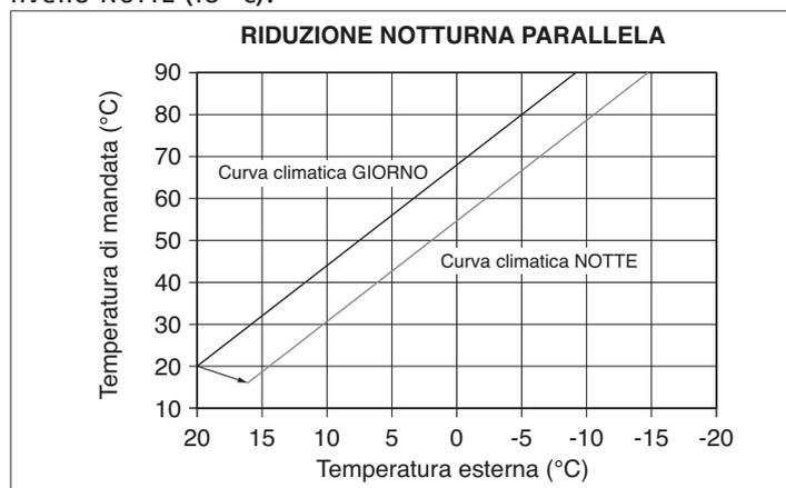
L'utente può indirettamente intervenire sul valore di setpoint RISCALDAMENTO andando ancora una volta ad introdurre, sul valore di temperatura di riferimento GIORNO (20°C) piuttosto che NOTTE (16°C), un offset che può variare all'interno del range [-5 ÷ +5].
