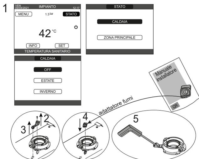
Conservare l'adattatore sonda analisi a corredo caldaia, nella busta documentazione.
