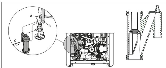
**Manutenzione dell'elettrodo ionizzazione**
