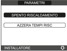
**SPENTO RISCALDAMENTO:** questo parametro consente di modificare la TEMPORIZZAZIONE SPENTO FORZATO RISCALDAMENTO, relativa al tempo di ritardo introdotto per la riaccensione del bruciatore a fronte di uno spento per raggiunta temperatura in riscaldamento. Il valore di fabbrica è di 3 minuti e può essere impostato e confermato ad un valore compreso fra 0 min e 20 min.
