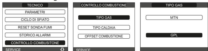
Per G230: impostare il parametro TIPO CALDAIA su F (vedi "3.27 Parametri Controllo combustione").
