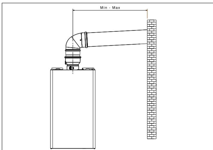
È possibile installare le curve e le prolunghe, disponibili come accessori, in base al tipo di installazione desiderato. Le lunghezze massime consentite del condotto fumi e del condotto aspirazione aria sono riportate nel capitolo "2.11 Scarico fumi ed aspirazione aria comburente".
