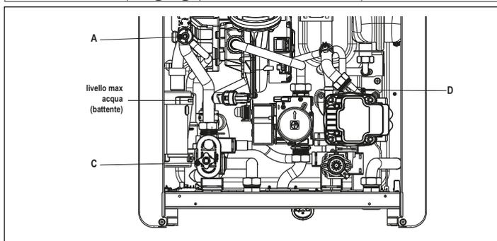
NOTA: anche se la caldaia è provvista di un dispositivo di riempimento semiautomatico, la prima operazione di riempimento dell'impianto deve essere fatta agendo sul rubinetto di riempimento (**esterno alla caldaia**) con caldaia in stato OFF.
