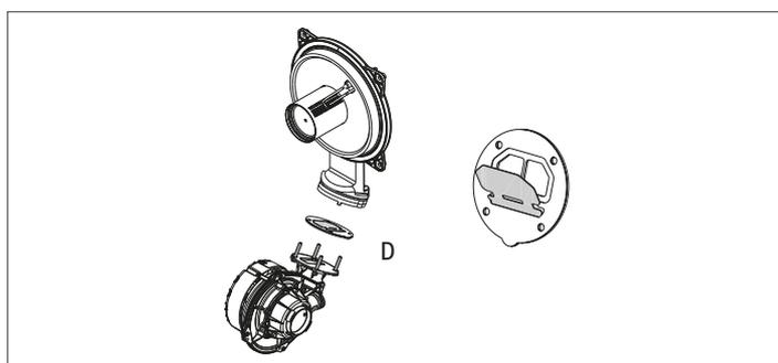
La caldaia è dotata di valvola di non ritorno (clapet).
