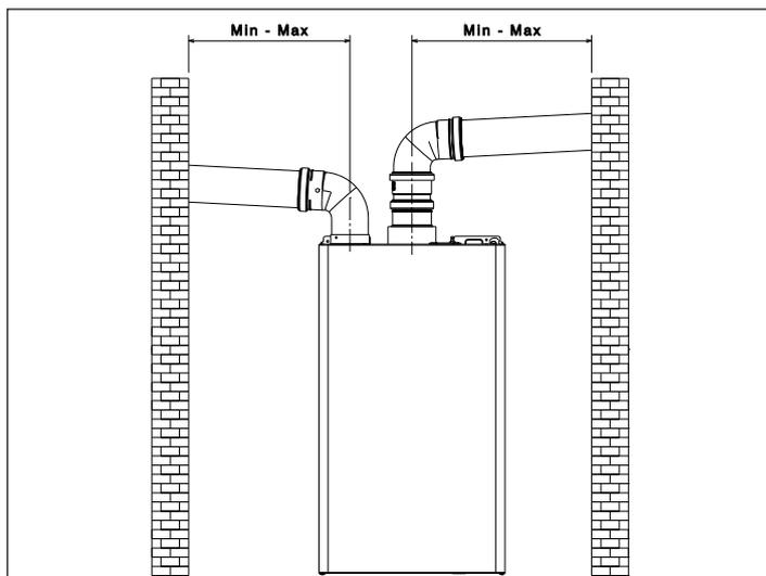
È possibile installare le curve e le prolunghe, disponibili come accessori, in base al tipo di installazione desiderato. Le lunghezze massime consentite del condotto fumi e del condotto aspirazione aria sono riportate nel capitolo "2.11 Scarico fumi ed aspirazione aria comburente".
