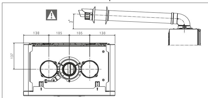
**⚠** La lunghezza rettilinea si intende comprensiva della prima curva (connessione in caldaia), di terminali e giunzioni. Viene fatta eccezione per condotto coassiale Ø 60-100 mm verticale, la cui lunghezza rettilinea si intende senza curve.
