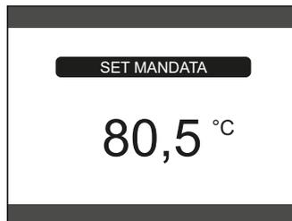
Successivamente viene chiesto di confermare l'impostazione del setpoint: selezionare **ENTER** oppure **BACK** mediante + e - e validare la scelta premendo il tasto **ENTER**.
