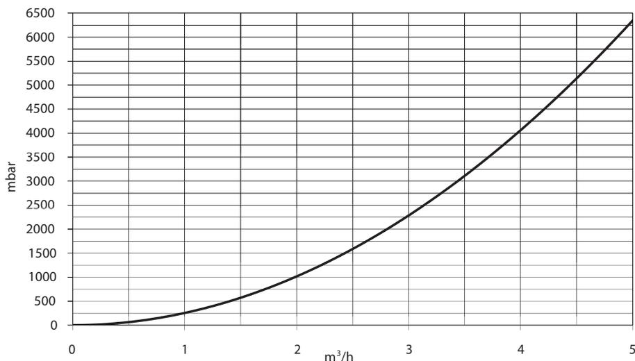
SCAMBIATORE SOLARE 1,21 m<sup>2</sup> PER 7200.500 HP E 7200.800 HP
