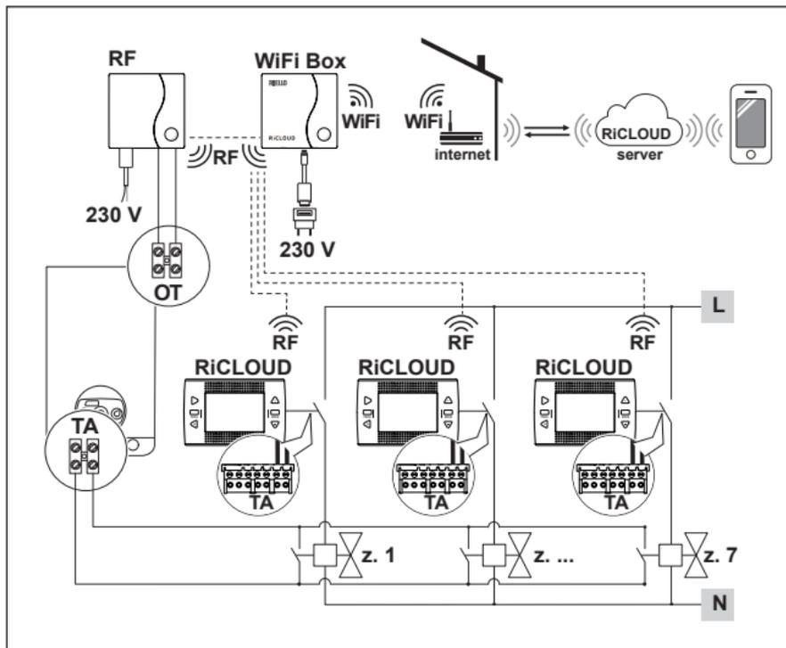
**IT** Con "Ricevitore RF Caldaia" fino a 7 zone.
