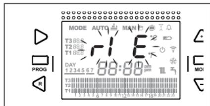
moet de toets ESC/MODE 5 seconden lang ingedrukt gehouden worden om de procedure van de halfautomatische vulling te starten (het opschrift rIE zal vast oplichten). Wanneer de toets ESC/MODE wordt losgelaten, begint het opschrift rIE langzaam te knipperen (2 sec) tot het einde van de functie.
