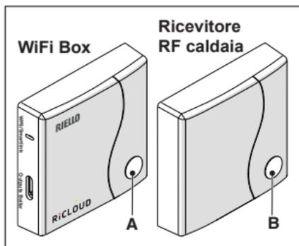
Sur le Récepteur RF chaudière, appuyer pendant 5 secondes sur la touche à LED transparente à bulle prismatique (B), jusqu'à obtention d'un clignotement simultané et rapide (0,5 sec) des LED verte et rouge.
