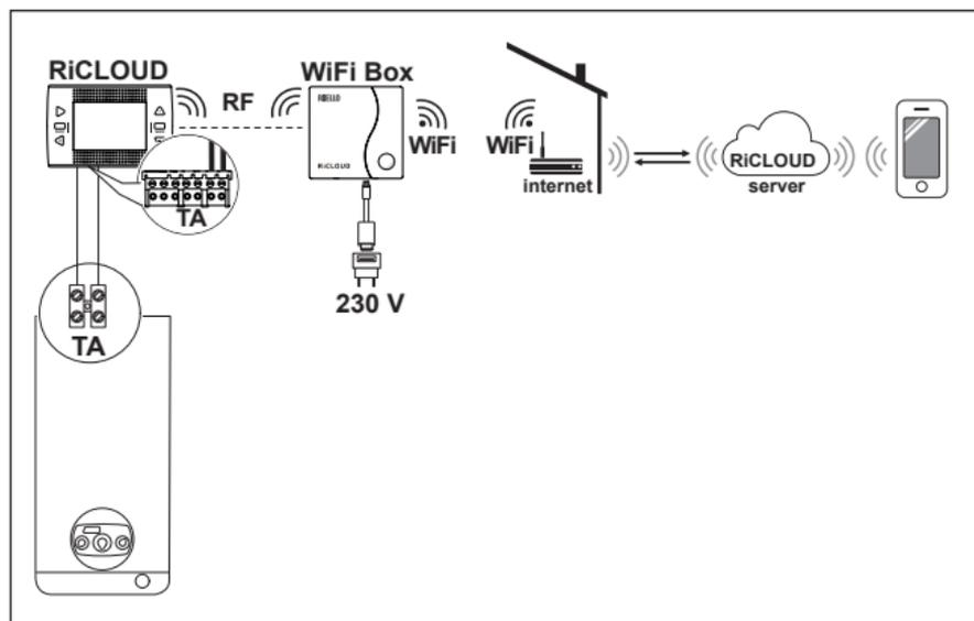
**IT** Cronotermostato modulante/comando remoto con controllo remoto mediante WiFi.
