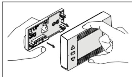
Fissare la base del **RiCLOUD** alla parete o scatola elettrica utilizzando le viti a corredo, utilizzare la livella ottica contenuta nell'involucro in plastica, per installare RiCLOUD perfettamente orizzontale.
