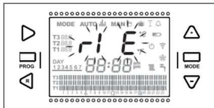
premere per 5 secondi il tasto ESC/ MODE per avviare la procedura di riempimento semiautomatico (la scritta rIE diventa fissa). Al rilascio del tasto ESC/ MODE la scritta rIE inizia a lampeggiare lentamente (2 sec) fino al termine della funzione.
