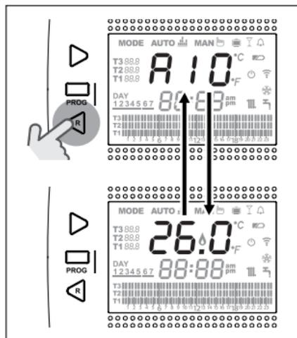
Indien een alarm ketel aanwezig is (beschikbaar met verbinding OTBus tussen WiFi Box en ketel, als het protocol OTBus dit voorziet) kan het gereset worden door 1 seconde lang de toets BACK/RESET < ingedrukt te houden (als het alarm A99 aanwezig is, moet de reset uitgevoerd worden vanaf de ketel).
