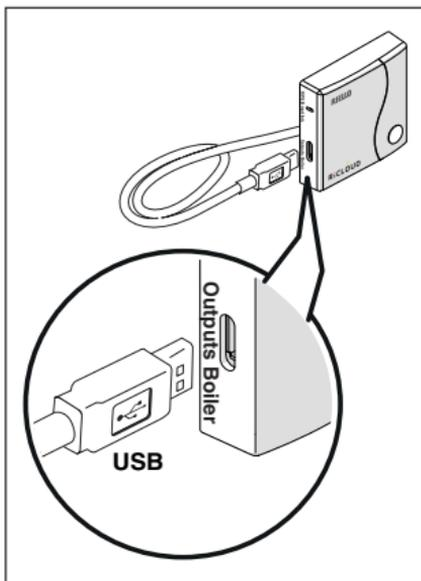
Alimentare il WiFi Box tramite l'apposito cavo e alimentatore forniti a corredo.
