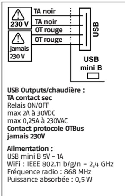
2 câbles USB sont fournis, un pour l'alimentation depuis le chargeur USB et l'autre pour la connexion du WiFi Box à la chaudière.
