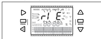
appuyer pendant 5 secondes sur la touche ESC/MODE pour démarrer la procédure de remplissage semi-automatique (l'indication rIE devient fixe). Dès que l'on relâche la touche ESC/MODE l'indication rIE commence à clignoter lentement (2 sec) jusqu'à la fin de la fonction.
