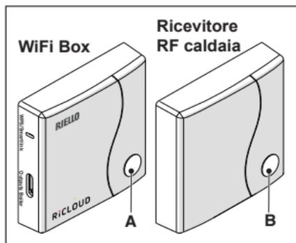
Spostarsi su Ricevitore RF caldaia, premere 5 sec. il tasto a LED trasparente a bolla prismatica (B) del Ricevitore RF caldaia, fino ad un lampeggio contemporaneo e veloce (0,5 sec) dei LED verde e rosso.
