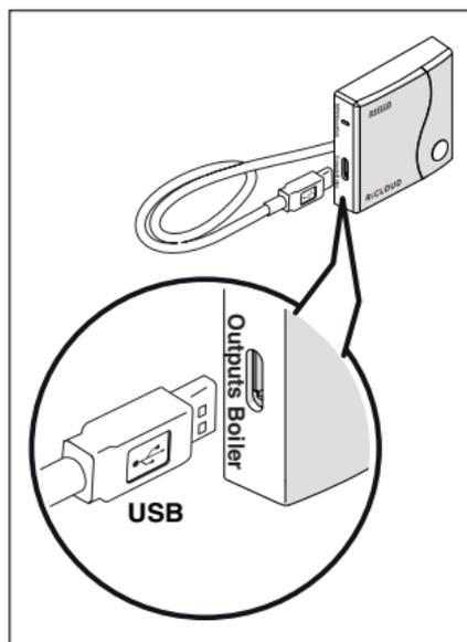
Voed de WiFi Box via de specifieke kabel en het bijgeleverde stroomvoorzieningstoestel.
