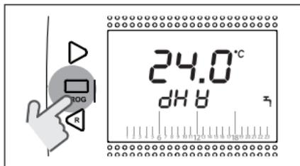
op de toets UP ^ of DOWN v om de setpointtemperatuur sanitair water te wijzigen.
