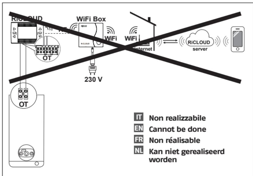
**IT** Cronotermostato ON/OFF sul riscaldamento (TA) con controllo remoto mediante WiFi.
