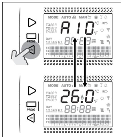
In presenza di un allarme caldaia (disponibili con collegamento OTBus tra WiFi Box e caldaia, se il protocollo OTBus lo prevede), è possibile resettare lo stesso, premendo per un secondo il tasto **BACK/RESET** < (se presente l'allarme A99, il reset deve essere eseguito da caldaia).
