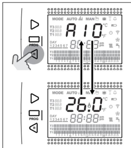
En présence d'une alarme chaudière (disponible avec connexion OTBus entre WiFi Box et chaudière, si le protocole OTBus le prévoit), il est possible de remettre à zéro l'alarme, en appuyant pendant une seconde sur la touche **BACK/RESET** (en présence de l'alarme A99, la remise à zéro doit être effectuée depuis la chaudière).
