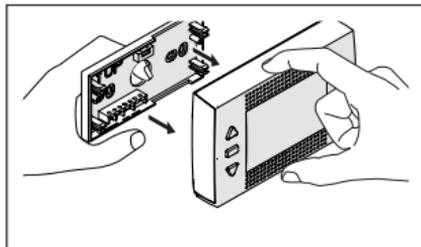
Bevestig de basis **RiCLOUD** op de wand of de schakelkast met behulp van de bijgeleverde schroeven, en gebruik de optische waterpas die in het plastic omhulsel is gestopt, om RiCLOUD perfect horizontaal te installeren.
