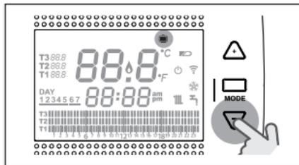
**!** De ingestelde setpointtemperatuur omgeving kan niet hoger/gelijk zijn dan/aan T3 (Comfort) en lager/gelijk zijn dan/aan T1 (Antivries).
