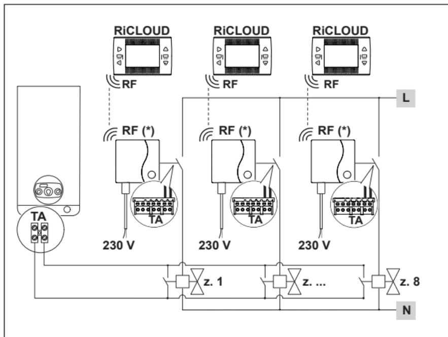
**IT** Gestione wireless di più dispositivi comandati da un unico **RiCLOUD** e delle valvole di zona tramite Ricevitore RF di zona(\*).
