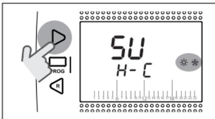
Druk op de toets SET/PROGRAM om te memoriseren en terug te keren naar het menu programmering, druk op ESC/MODE om te memoriseren en het menu van de programmering te verlaten, of wacht 30 seconden om de waarde automatisch te memoriseren en terug te keren naar het beeldscherm HOME.
