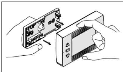
Fixer la base du **RiCLOUD** à la paroi en utilisant les vis fournies, utiliser le niveau optique contenu dans l'emballage pour installer RiCLOUD en position parfaitement horizontale.
