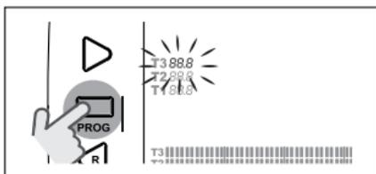
Appuyer sur la touche FORWARD  $\>$  ou BACK  $\<$  pour sélectionner la température à modifier.
