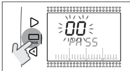
Premere il tasto UP ^ o DOWN v per inserire la password installatore (password = 18).
