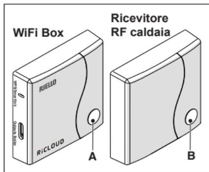
Druk nu 5 seconden lang op de doorzichtige LED toets met prisma (B) van de Ontvanger RF ketel, tot de groene en rode LED gelijktijdig en snel (0,5 sec) beginnen te knipperen.
