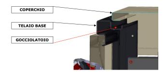
Per ottenere il grado di protezione necessario per l'installazione all'esterno (IPX5D) è sufficiente installare sul codice standard un kit specifico comprendente solo quattro staffette per la protezione della parte idraulica ed un coperchio per la protezione del quadro di controllo.
