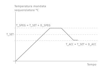
è riduzione della temperatura e questa eccede di un valore pari a DELTA OFF il limite sopra impostato il controllo fiamma spegne il bruciatore. Il bruciatore viene poi riacceso quando la temperatura dell'acqua del modulo è scesa di un valore pari a DELTA ON al disotto del valore espresso al parametro P517.
