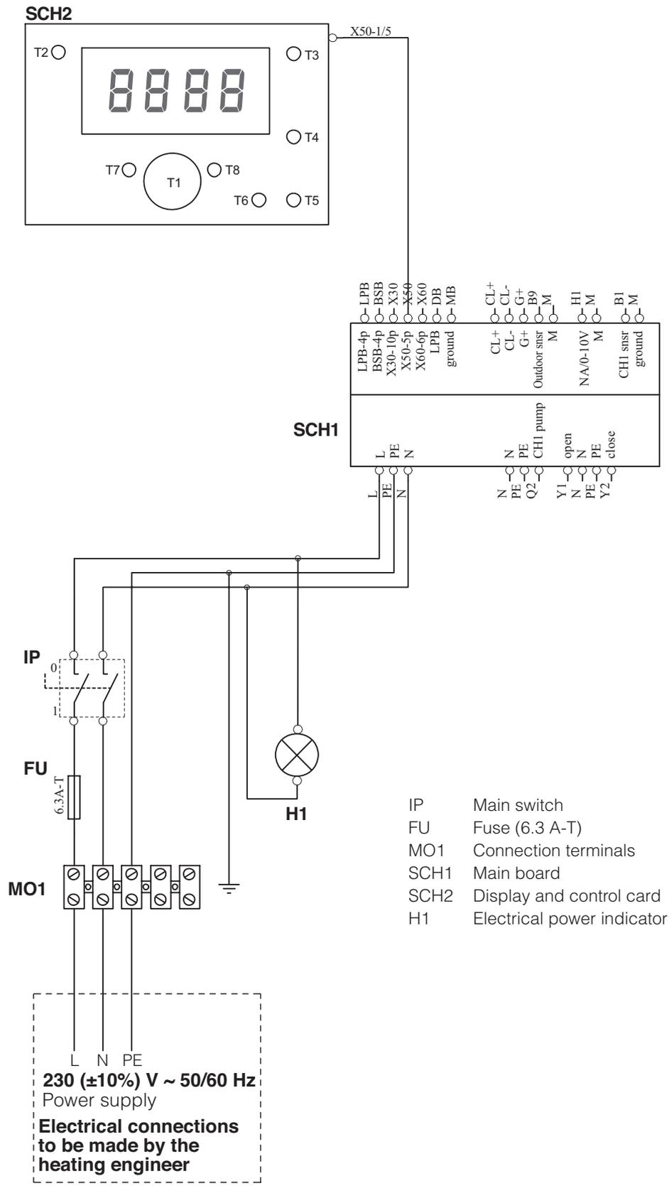
**TYPICAL COMPONENT CONNECTION DIAGRAM FOR SYSTEM WITH RIELLOtech CLIMA MIX CONTROL PANEL**
