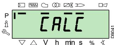
La boîte de contrôle calculera automatiquement les points de « **P8** » à « **P2** », en les distribuant sur une ligne droite. Ils sont théoriques et doivent être vérifiés.
