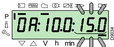
Pour le réglage de la vitesse de l'inverter (exprimée en % à savoir **50 Hz = 100 %**), maintenir la pression sur les touches « **F** » et « **A** » simultanément la position en pourcentage clignote et appuyer sur les touches « **+** » ou « **-** » pour augmenter ou diminuer la valeur.
