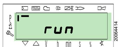
Confirmer avec la touche «i/reset». le brûleur démarre. L'écran affiche en séquence toutes les phases et les temps correspondants. Les phases sont énumérées dans le paragraphe Liste des phases (fonctionnement au gaz).
