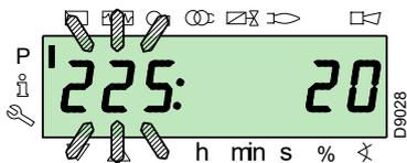
Si la valeur n'est pas affichée, appuyer sur la touche «i/reset» pendant un temps compris entre 1 et 3 secondes. Ci après voici un exemple de modification du paramètre relatif au **temps de prévention** (n. 225).
