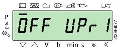
Accéder au niveau Paramètres en se référant à la Procédure d'accès par mot de passe. L'écran affiche le groupe des paramètres 400.
