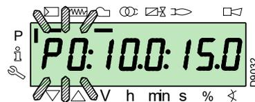
Pour le servomoteur du combustible, continuer à appuyer sur la touche «F» (la position en degrés clignote) et appuyer sur les touches «+» ou «-» pour augmenter ou diminuer la valeur.
