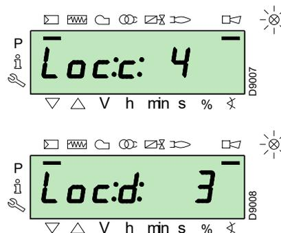
L'afficheur affiche alternativement un code et un diagnostic d'erreur, qui ne met pas le système en sécurité.
