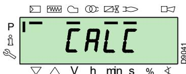
L'équipement calculera automatiquement les points de «P8» à «P2», en les distribuant sur une droite. Ils sont théoriques et doivent être vérifiés.
