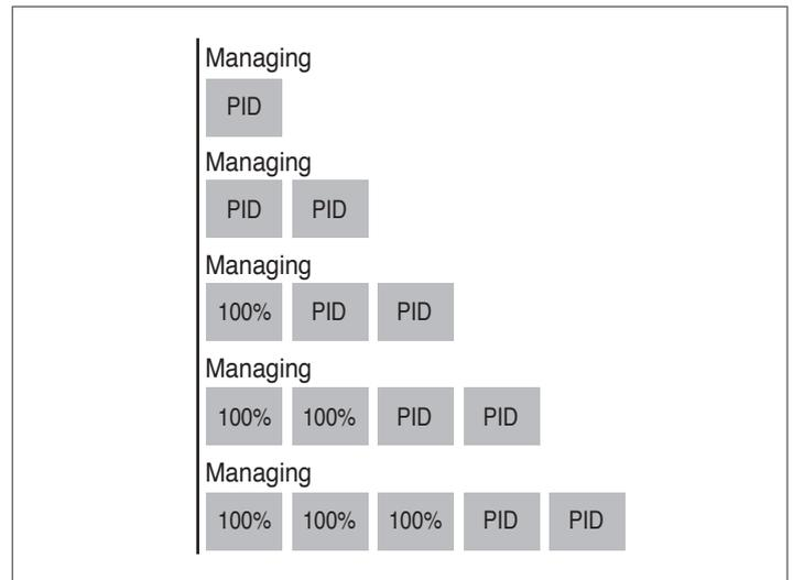
En pratique, si le nombre de modules thermiques allumés est supérieur à deux, seuls deux modules thermiques sont pilotés par PID, tandis que les autres reçoivent un signal pour atteindre la puissance maximale.
