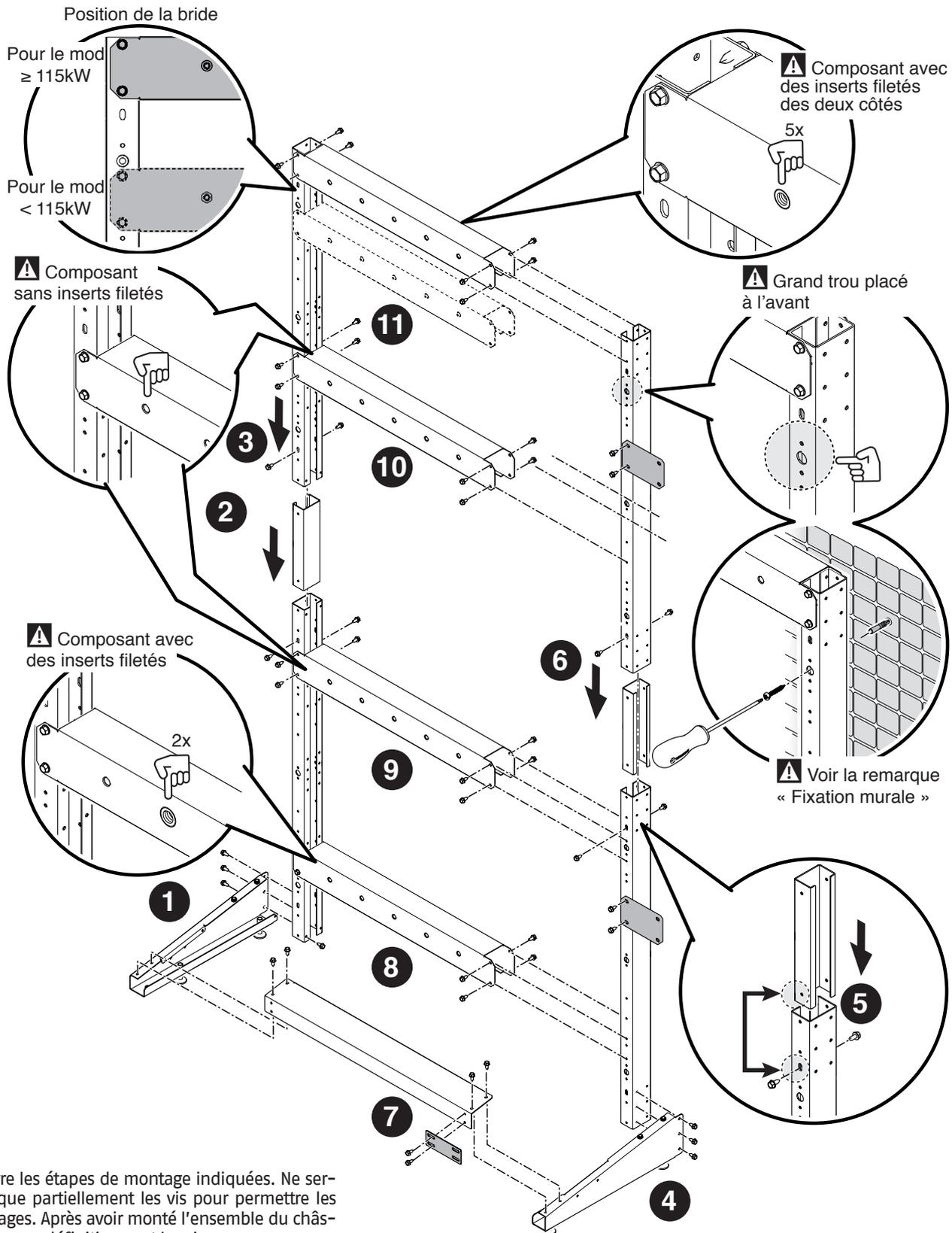
**⚠** Suivre les étapes de montage indiquées. Ne serrer que partiellement les vis pour permettre les réglages. Après avoir monté l'ensemble du châssis, serrer définitivement les vis.
