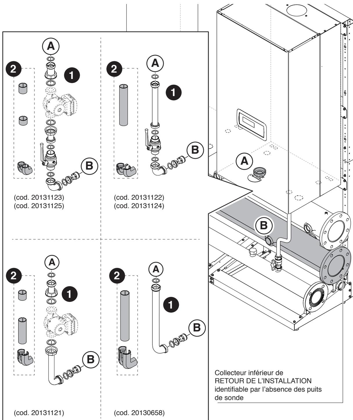
Fixation des bouchons sur les raccords non utilisés.
