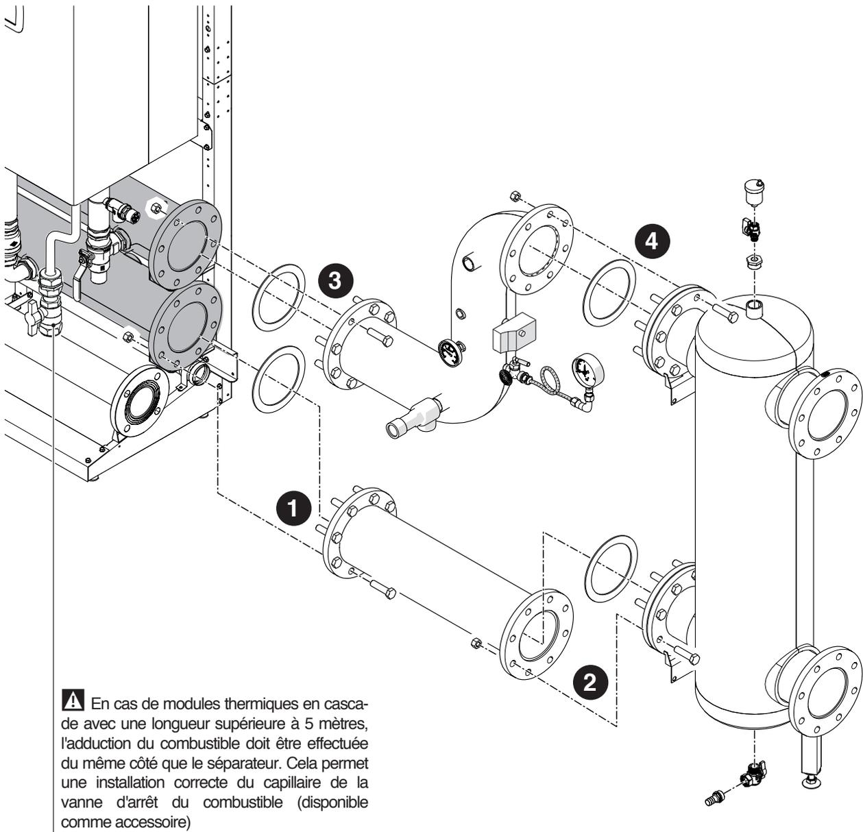
Une fois tous les raccords hydrauliques terminés, il est possible d'effectuer l'essai d'étanchéité de l'installation et de monter les isolations pour compléter le système.
