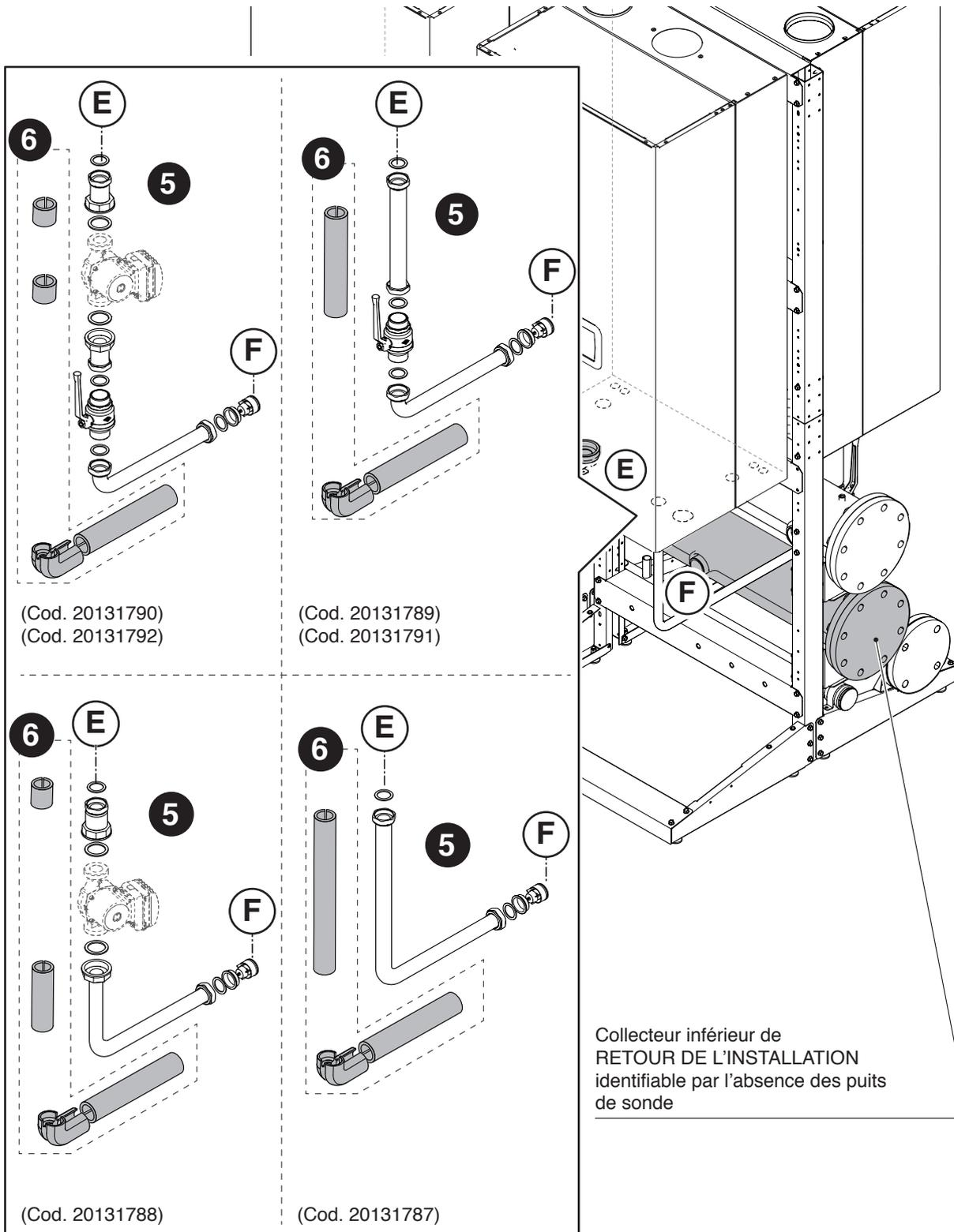
**A** Fixation des bouchons sur les raccords non utilisés.
