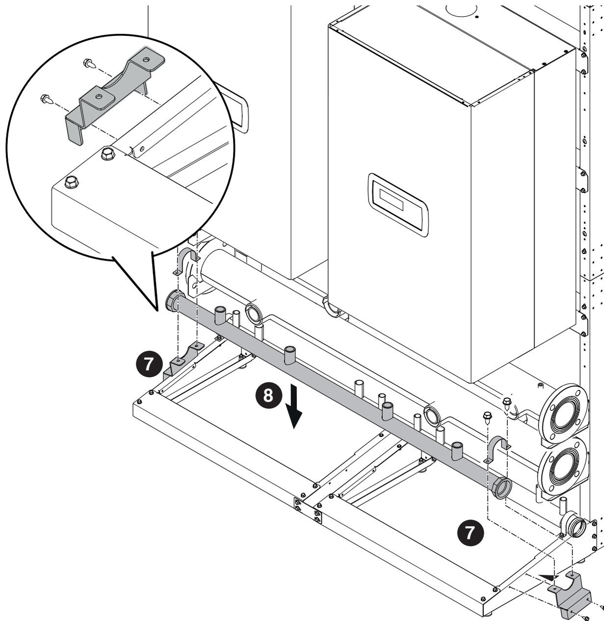
9 Positionnement des bouchons de fermeture des collecteurs du côté souhaité.
