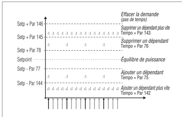
Six bandes sont définies sur la base de la température lue (par le module de gestion) sur le collecteur de refluxement de la circuit primaire.
