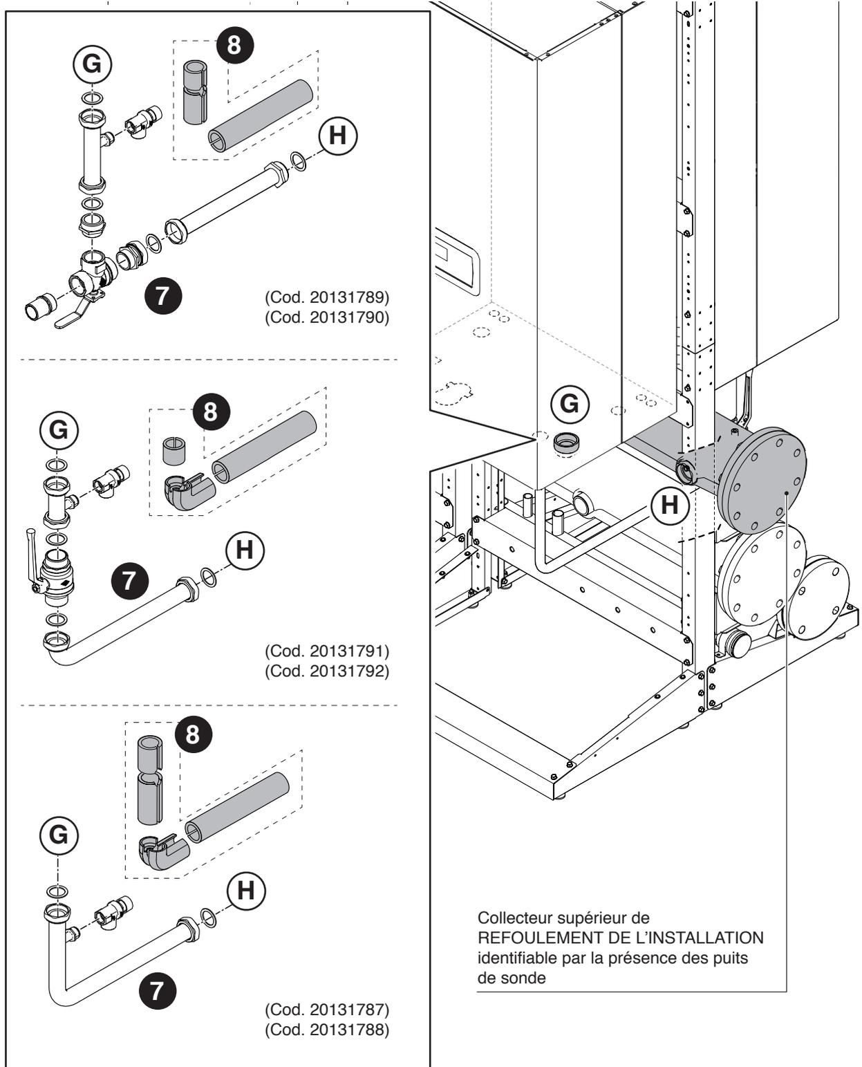
**A** Fixation des bouchons sur les raccords non utilisés.
