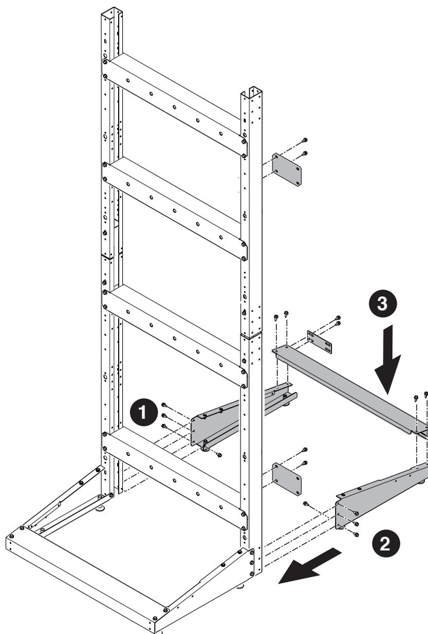
**⚠** Suivre les étapes de montage indiquées. Ne serrer que partiellement les vis pour permettre les réglages. Après avoir monté l'ensemble du châssis, serrer définitivement les vis.
