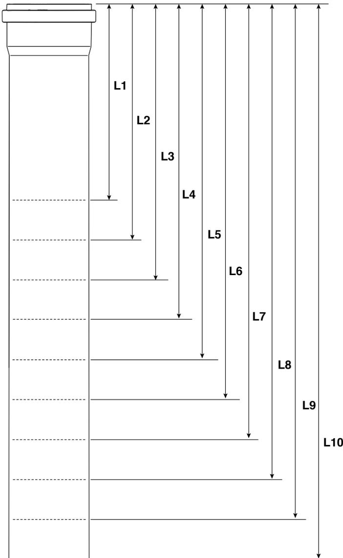
**⚠** UNIQUEMENT POUR LES MODÈLES Condexa PRO 57 P et Condexa PRO 70 P avec une sortie des fumées DN80, un adaptateur DN80/DN110 doit être installé sur la sortie du conduit de fumée. Cela signifie que, dans ce cas, les longueurs de coupe doivent être réduites de 60 mm.
