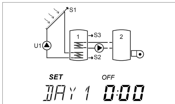
Door te drukken op "▲" of "▼" is het mogelijk door de 24 uur van de aangegeven dag te scrollen en de configuratie weer te geven. De pictogrammen "ON" en "OFF" geven de status van de brander of van het thermische integratiesysteem van het betreffende halve uur aan:
