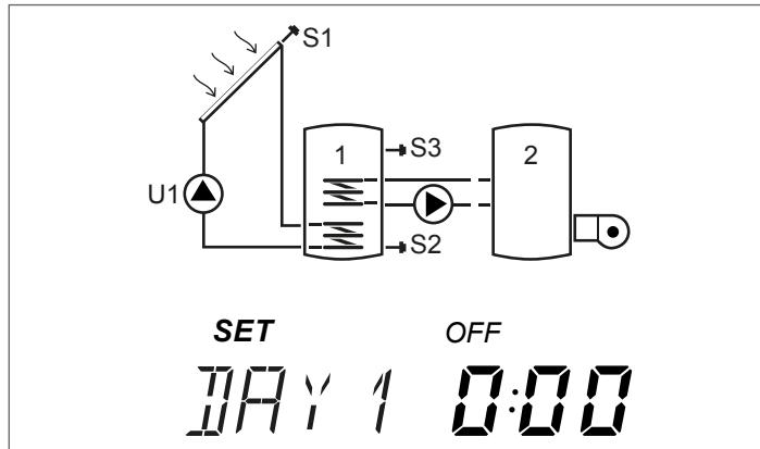
Durch Drücken auf „▲“ oder „▼“ können alle 24 Stunden des angegebenen Tags durchgeschrollt und die Konfiguration angezeigt werden. Die Icons „ON“ und „OFF“ geben den Status des Brenners oder des Wärmeintegrationssystem in der betreffenden halben Stunde an:
