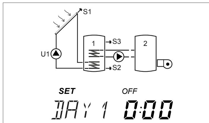
Premindo "▲" ou "▼" é possível percorrer todas as 24 horas do dia indicado e visualizar a configuração. Os ícones "ON" e "OFF" indicam o estado do queimador ou do sistema de integração térmica na respetiva meia hora:
