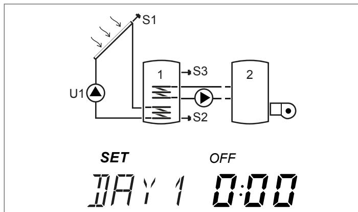
Presionando "▲" o "▼" es posible desplazarse por las 24 horas del día indicado y visualizar la configuración. Los iconos "ON" y "OFF" indican el estado del quemador o del sistema de integración térmica en la media hora correspondiente:
