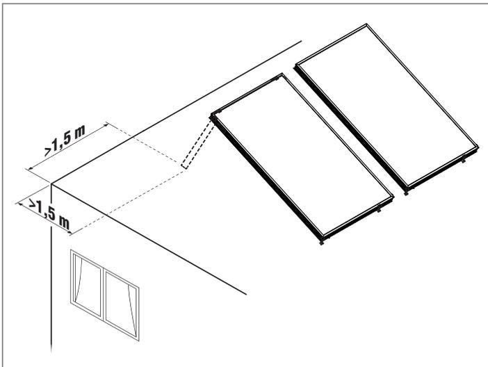
**!** Les collecteurs doivent être installés en respectant la distance de sécurité par rapport aux parties actives des lignes et des installations électriques selon les normes et les réglementations en vigueur dans le pays d'installation.
