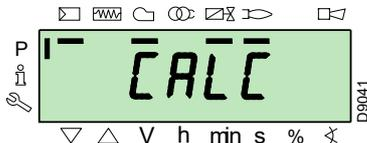
La boîte de contrôle calculera automatiquement les points de « P8 » à « P2 », en les distribuant en ligne droite. Ils sont théoriques et doivent être vérifiés.
