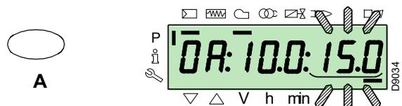
Pour régler la vitesse du variateur de fréquence (exprimée en %, à savoir 50 Hz = 100 %), garder simultanément enfoncés les boutons « F » et « A » - la position en pourcentage clignote - et appuyer sur les boutons « + » ou « - » pour augmenter ou diminuer la valeur.
