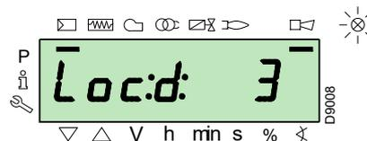
L'afficheur visualise alternativement un code et un diagnostic d'erreur, ce qui ne met pas le système en sécurité.
