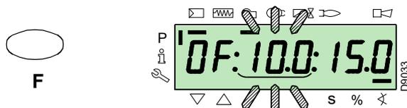
Pour le servomoteur de l'air, garder le bouton « A » enfoncé (la position en degrés clignote) et appuyer sur les boutons « + » ou « - » pour augmenter ou diminuer la valeur.
