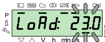
Pour sortir du mode manuel, appuyer simultanément sur les boutons « **+** » et « **-** » (**ESC**) pendant 3 secondes : le brûleur fonctionnera en mode automatique et la puissance dépendra du thermostat/pressostat de réglage (TR).
