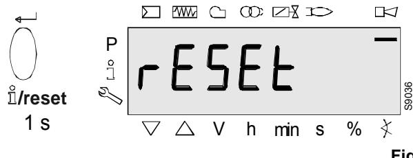
Presionando **i/reset** durante 1 segundo, **rESEt** se visualiza en el display. Al soltar el pulsador, se reinicia la unidad base.
