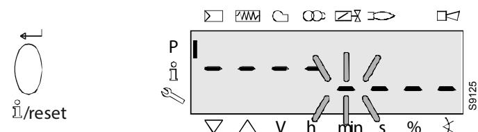
Nadat u het laatste teken heeft ingevoerd, moet het wachtwoord worden bevestigd door op "i/reset" te drukken.
