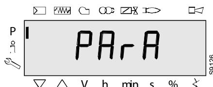
Bij bevestiging van de correcte invoer wordt **PArA** weergegeven gedurende maximaal 2 seconden.
