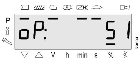
La visualización **oP:** significa funcionamiento modulante.
