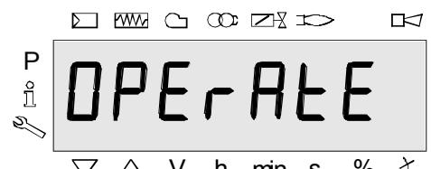
Presionando **i/reset** durante > 3 segundos se visualizan en el display **Info**, **SEr** y luego **OPErAtE**.
