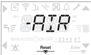
要中断排气循环，请按RESET。按 ⏻ 将锅炉停机。
