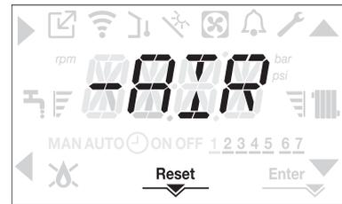
按键 2，可以退出排气循环（图标RESET亮起）。
