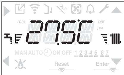
屏幕通常显示采暖出水温度。如果有生活热水请求，则显示生活热水温度。
