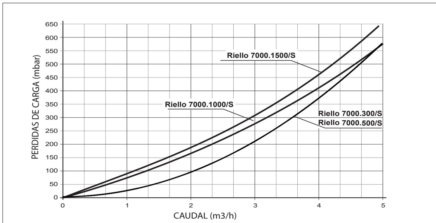
**Pérdidas de carga kit serpentín intercambiador (solamente para los modelos Riello 7000.2000/F - 3000/F - 5000/F)**
